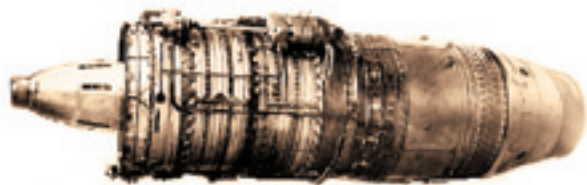
Турбореактивный двигатель AM-3 (РДЗМ). Генеральный конструктор – А.А. Микулин Начало серийного производства - 1952 г. Самый мощный в мире ТРД для своего времени. Применение: Ту-16, Ту-104 (первый в мире пассажирский самолет с реактивным двигателем).
