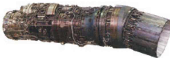
Двухконтурный турбореактивный двигатель с форсажной камерой АЛ-31Ф. Генеральный конструктор – А.М. Люлька Начало серийного производства - 1985 г. Первый в мире серийный авиадвигатель, на котором был реализован с помощью поворотного сопла управляемый вектор тяги. Применение: Су-27 и все его модификации
