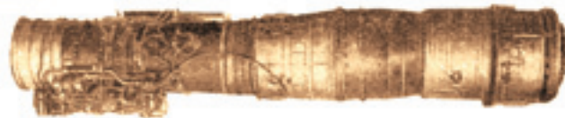
Турбореактивный двигатель с форсажной камерой Р11Ф2-300.
