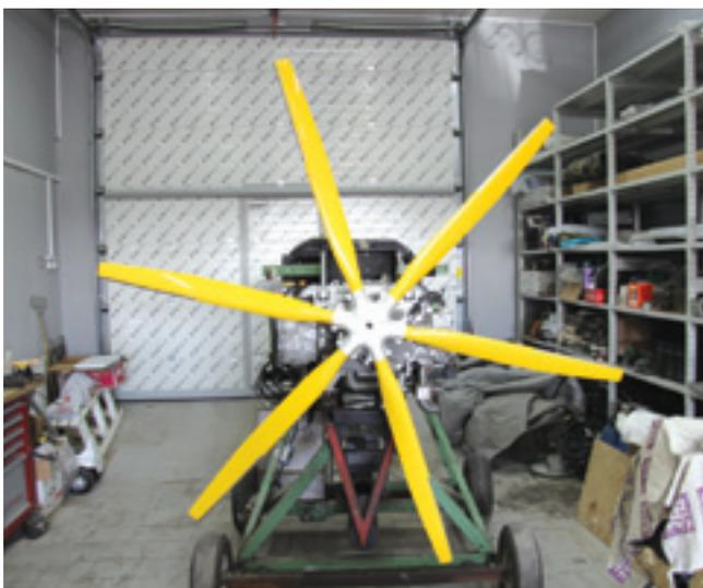
*Стенд для испытания двигателей (на фото двигатель Subaru EG 3.6 с воздушным винтом Finish-Prop, г. Казань)*
