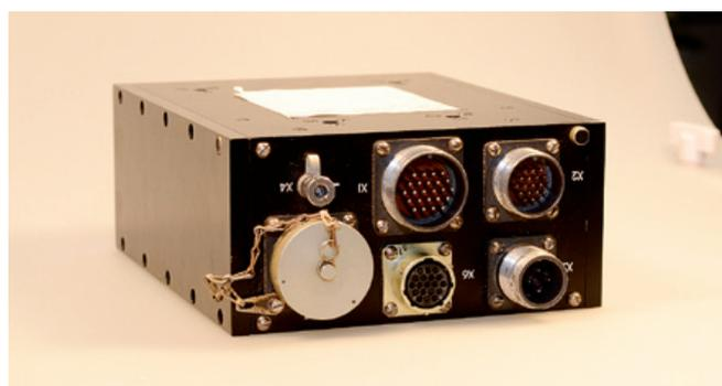
БАРК-78 для двигателя ВК-2500 – первый блок автоматического регулирования и контроля, самостоятельно разработанный на заводе имени В. Я. Климова
