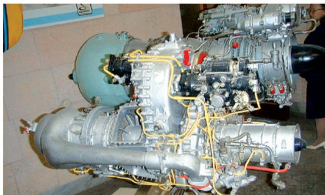
ГТД-350 – малоразмерный газотурбинный двигатель, состоящий из осецентробежного компрессора, одноступенчатой турбины компрессора, двухступенчатой свободной турбины и промежуточного редуктора. В силовую установку вертолета входят два взаимозаменяемых двигателя ГТД-350 и главный редуктор ВР-2. Первые образцы были изготовлены в 1961 году. В 1963 году двигатель прошел государственные испытания.
