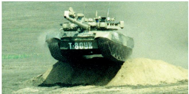
«Восьмидесятку» приняли на вооружение Советской армии в 1976 году. Это был первый газотурбинный танк в мире. Проект танка за несколько лет разработки успел претерпеть массу изменений. Корректировались почти все элементы конструкции. То же было и с газотурбинным двигателем. На фото: «Летающий танк» Т-80У
