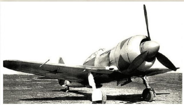
Опытный Ла-7 с мотором М-71Ф
