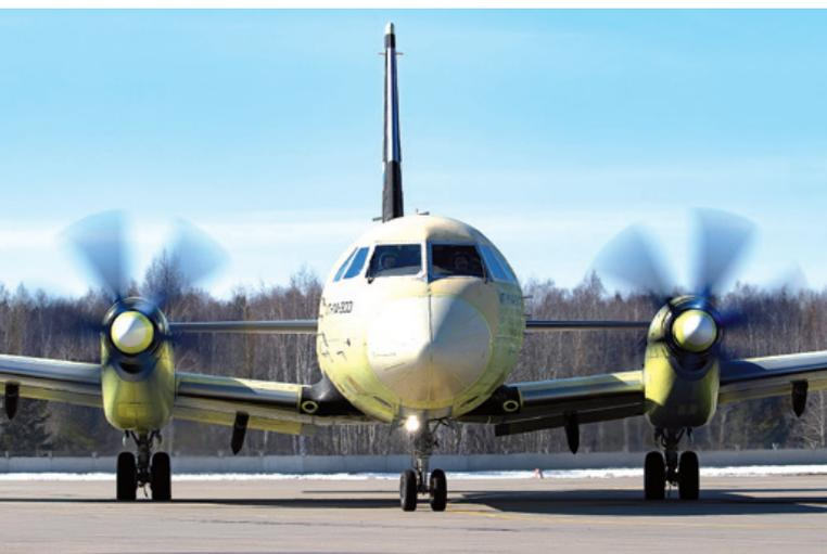
Опытный самолёт Ил-114-300 с двумя ТВ7-117СТ-01 мощностью по 2500 л.с. и с винтами АВ112-114 производства НПП «Аэросила», имеющими повышенную тягу 4 тонны, совершил первый полёт 31 марта 2024 года
