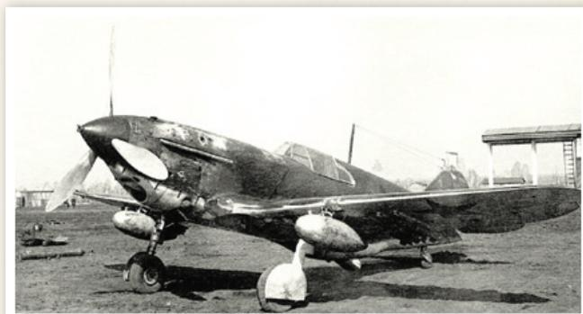
ЛаГГ-3 с подвесными топливными баками
