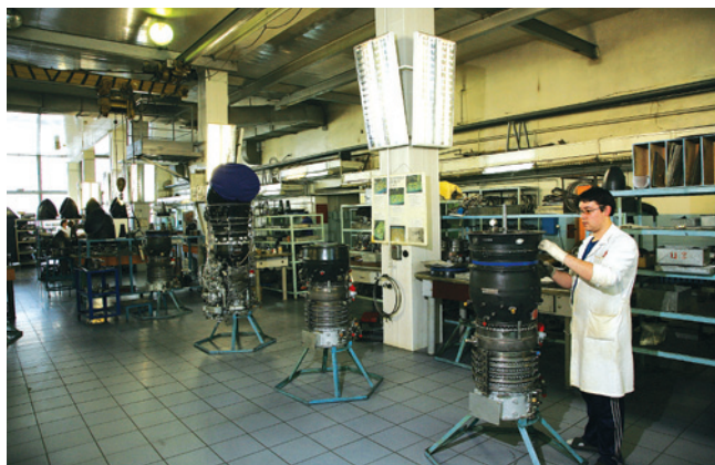
Участок сборки двигателей ТВ3-117
