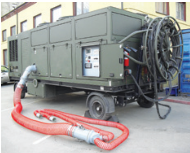
Аэродромный кондиционер АК 1,0-30-1-1
