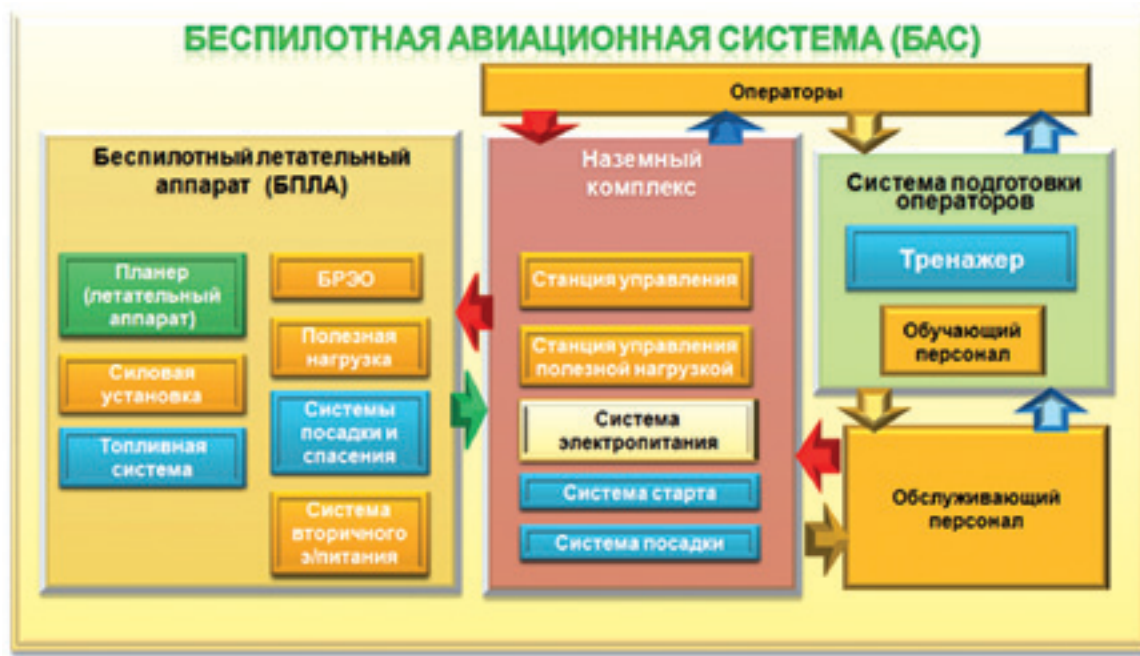
Рис. 6. Состав основных элементов БАС
