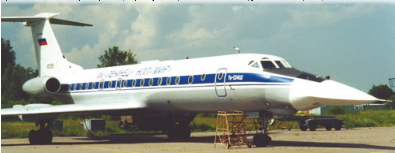
Летающая лаборатория (Л 17-10В) на базе самолета Ту-134Ш, на которой проходили отработки РЛС самолетов Су-34
