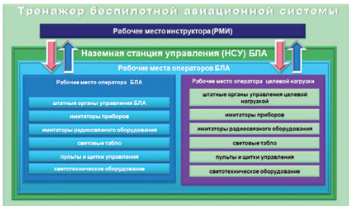
Рис. 8. Обобщенная структурная схема тренажера из состава БАС
