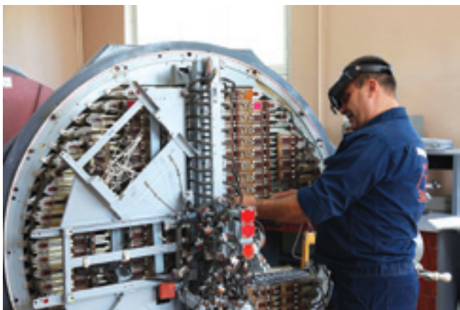
Ремонт и настройка фазированной антенны
