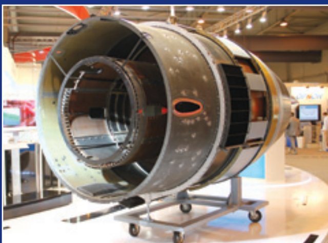
Элементы двигателя ПС-90А2 из композитных материалов
