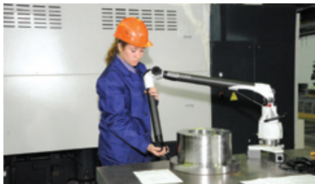
Координатно-измерительная машина SIMCORE
