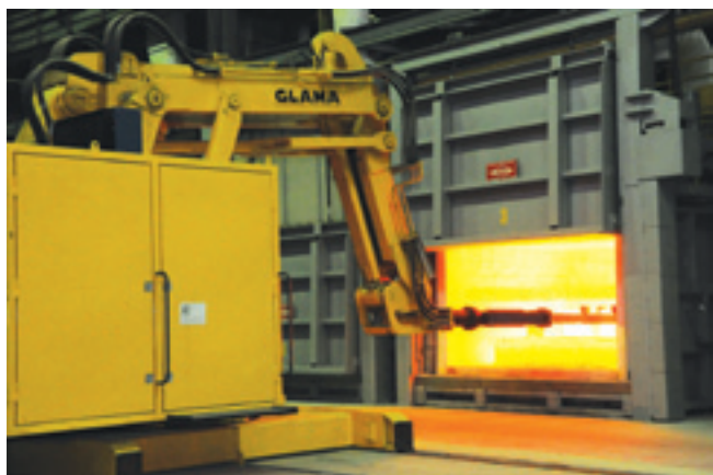
Робот-манипулятор GLAMA производит загрузку заготовок в нагревательную печь LOECHER
