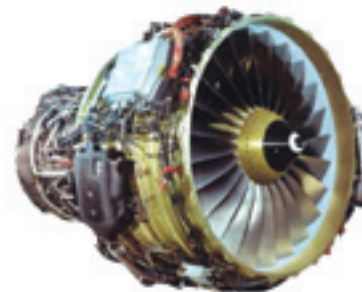
Рис. 1. Газотурбинный двигатель CFM-56 с установленной на нем системой управления ( http://www.safran-group.com/site-safran-en/aerospace/aerospace-propulsion/commercial-aircraft-engines/cfm-56/ )
