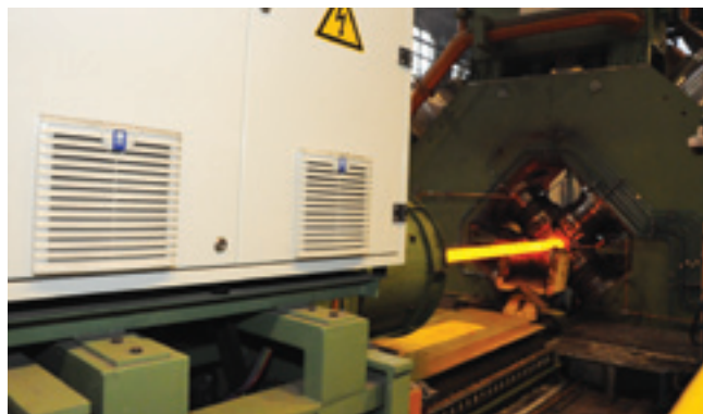
Ковка прутковой заготовки на радиально-ковочной машине SMX 600/1200 компании SMS MEER
