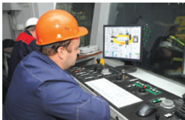
Пульт управления кольцераскатного стана RAW 400/200-3000/600 компании SMS MEER
