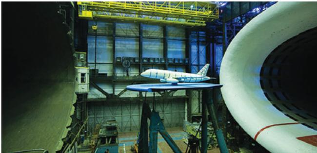
над центропланом. Были проведены эксперименты в рамках НИР «Разработка концепций для создания магистральных и региональных самолетов следующего поколения». Цель экспериментальных исследований – получение характеристик воздухозаборника в компоновке ЛА типа «летающее крыло» на взлетно-посадочных режимах. Результаты позволяют проверить корректность его использования и определения допустимых режимов эксплуатации в составе ЛА.
