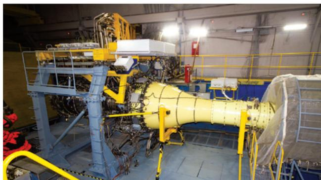
Газогенератор двигателя сверхбольшой тяги ПД-35
