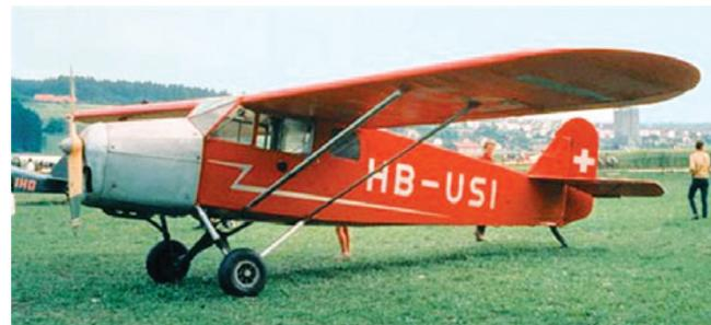
Самолёт Compte AC-4 HB-USI после обратного переоснащения бензиновым двигателем
