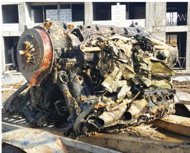
Мотор AM-35 самолета Виктора Киселева
