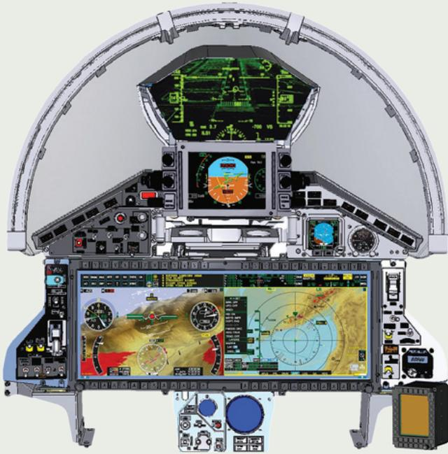
За проекцию на лобовое стекло тактической, навигационной и боевой информации отвечает перспективный широкоформатный коллиматорный индикатор с увеличенным полем зрения и углом обзора, управление им осуществляется посредством жидкокристаллического пульта управления с сенсорным экраном, на который также выводятся данные с резервных приборов.
