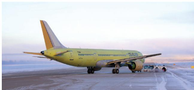
Помимо устойчивости и управляемости была проверена работа противобледенительных систем самолета МС-21-300. Согласно действующим нормам, для повышения безопасности при испытаниях подтверждается способность самолета продолжать полет при неработающей противобледенительной системе. Также в условиях обледенения была проверена работа ряда систем самолета, в частности, внешней светотехники, радиосвязного оборудования и шасси.
