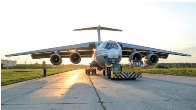
Самолет Ил-76МД-90А создан на базе Ил-76МД в целях дальнейшего совершенствования самолетов этого типа и расширения их транспортных возможностей за счет модернизации крыла и установки более мощных, экономичных и малошумных двигателей ПС-90А-76 взамен двигателей Д-30КП-2.
