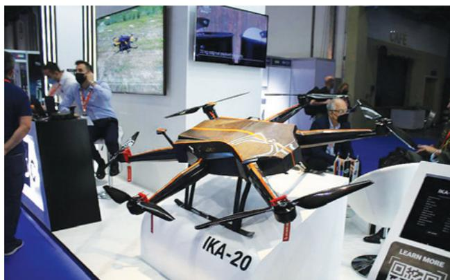
стандартную 12-миллиметровую рельсовую систему. Силовая установка основана на шести изолированных двигателях, каждый из которых состоит из двигателя с двухлопастным винтом.
