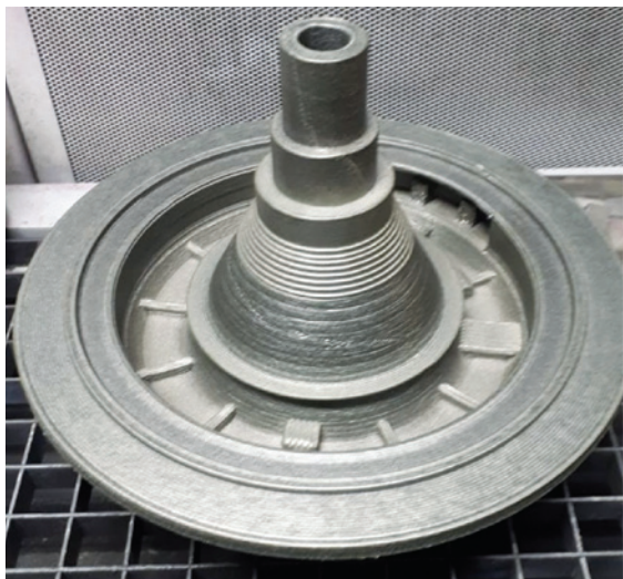
Заготовка из жаропрочного сплава Inconel 625, выращенная на гибридном комплексе
