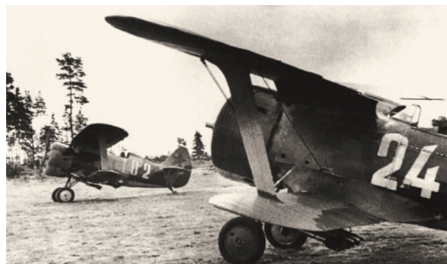
Истребители И-153 71-го ИАП ВВС КБФ перед вылетом на боевое задание. Под крыльями самолетов подвешены реактивные снаряды РС-82
