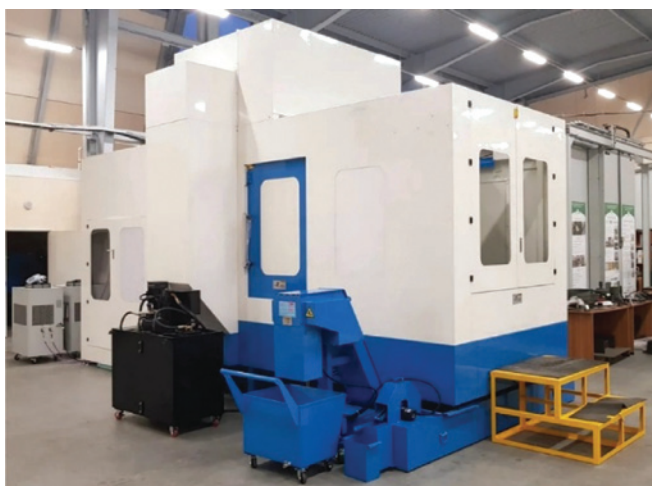
Гибридный комплекс для прямого лазерного выращивания и механической обработки
