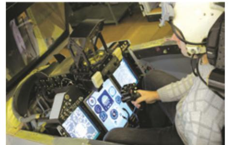
**Макет кабины на комплексе полунатурного моделирования истребителя**
