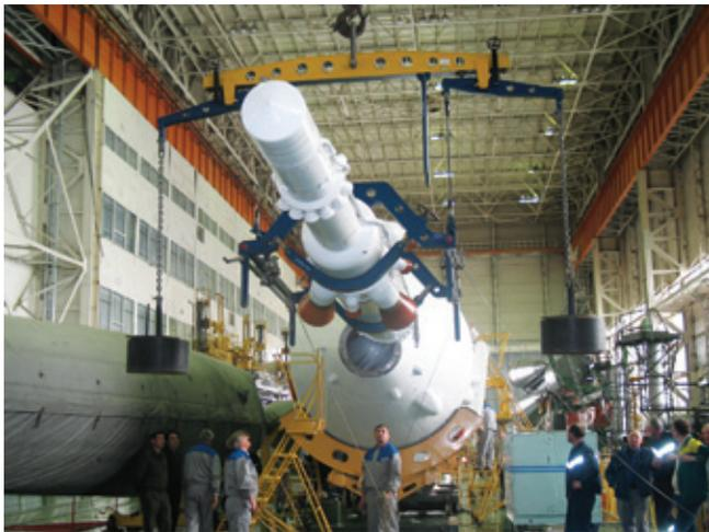
**Монтаж двигательной установки системы аварийного спасения экипажа космического корабля «Союз»**
