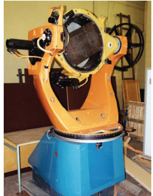
**Стенд СЗ-600 для моделирования гиросинерциальных платформ**
