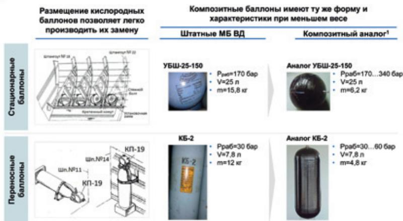
Рис.5. Замена штатных металлических баллонов на металлокомпозитные в кислородной системе самолета Ил-76
