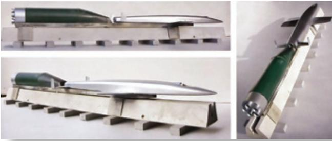
**Макет «волнолета» с разгонной тележкой на эстакаде**
