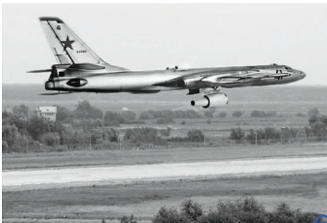
**Ту-16ЛЛ для исследования турбореактивных двигателей. На фотографии - двигатель Д-36, 1976 г.**
