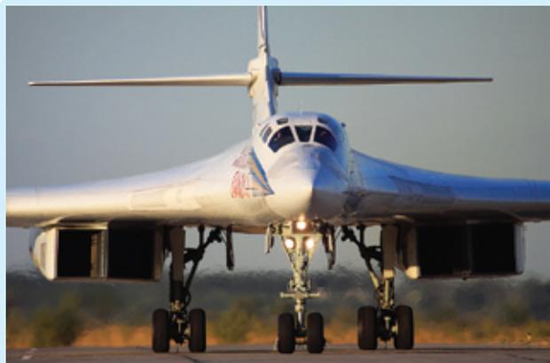
Ту-160 – межконтинентальный сверхзвуковой стратегический бомбардировщик-ракетоносец. Самолёт выполнен по схеме низкоплана с крылом изменяемой стреловидности, трёхопорным шасси, цельноповоротным стабилизатором и килем. Два грузовых отсека для размещения боевой нагрузки расположены тандемом; в них размещаются многопозиционные пусковые установки револьверного типа для обеспечения применения ракетного вооружения.
