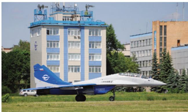
**Летающая лаборатория МиГ-29 УБ для летных исследований и отработки инерциальных, спутниковых и инерциально-спутниковых навигационных систем маневренных самолетов на фоне КДП-1**
