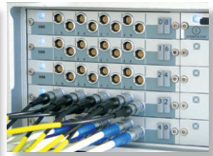
**Многоканальная система сбора данных LMS SCADAS (SIEMENS).**
