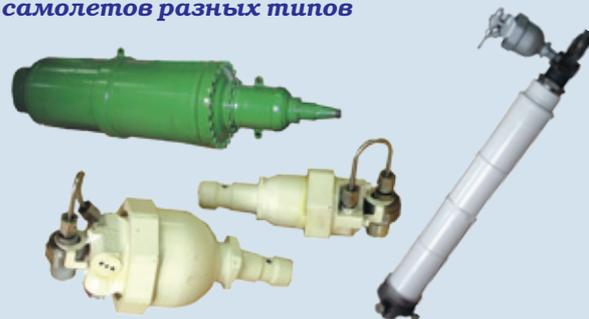
**Особым направлением работ «Искры» является разработка и создание твердотопливных газогенераторов, которые находят применение в различных областях техники**
