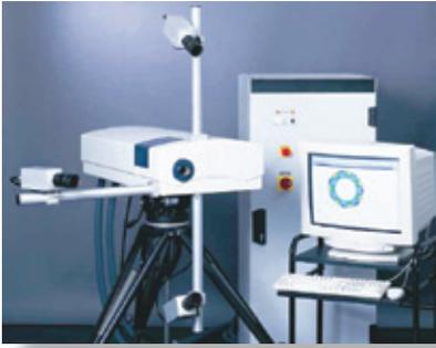
**Dantec Dynamics. Оптическая система для исследования форм колебаний**
