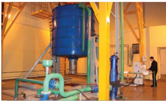
**В объединении разработан уникальный испытательный стенд для определения пропускной способности сопловых аппаратов вертолетного двигателя типа ВК-2500, что позволило оптимизировать затраты и в разы ускорить производство изделия**
