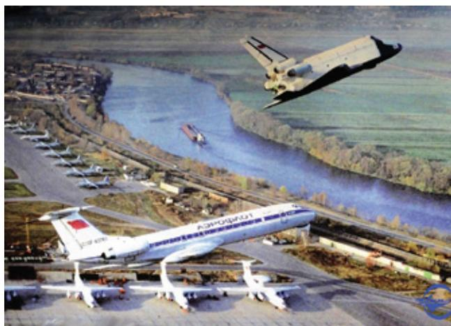
**Полноразмерный аналог космического корабля «Буран» и летающая лаборатория Ту-154 для отработки системы автоматической посадки, 1986 г.**
