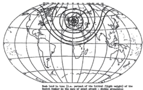
**Границы досягаемости ракетного бомбардировщика при скорости истечения газов 4000 м/с и различных значениях массы полезной нагрузки**
