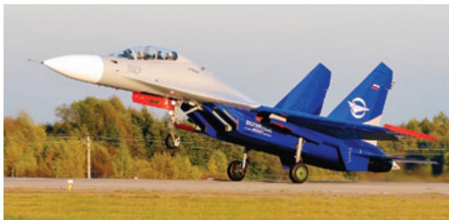
**Летающая лаборатория Су-30 для проведения испытаний силовых установок в большом диапазоне высот и скоростей**
