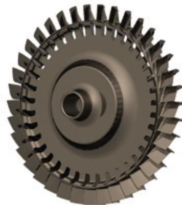
**Модель биметаллического «блиска» турбины**
