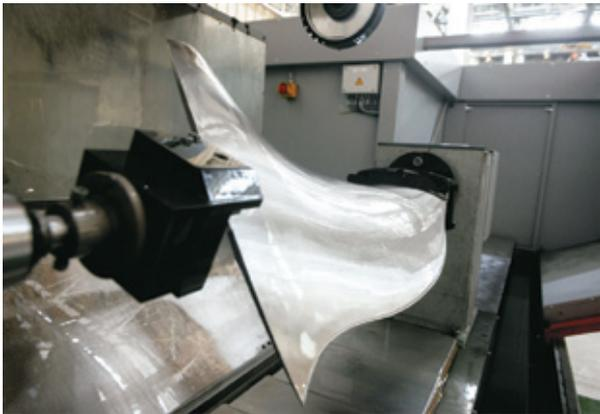
**Только на УМПО изготавливается полая широкохордная вентиляторная лопатка ПД-14 - технология ее производства - достояние объединения**
