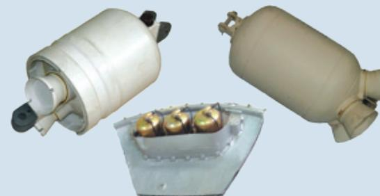
**Двигатели мягкой посадки используются в системах приземления космических аппаратов («Восток», «Союз»), а также при десантировании грузов**
