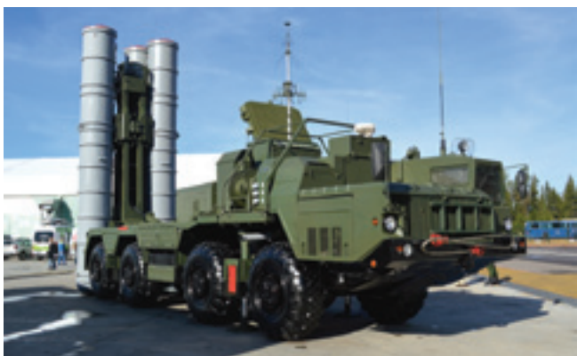
Пусковая установка ЗРК С-300 ПМУ-1
