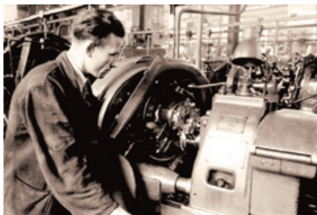
1952г. Изготовление шестерни хвостового редуктора
