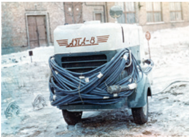
Передвижной универсальный аэродромный пусковой агрегат АПА-8 на базе двигателя АИ-8
