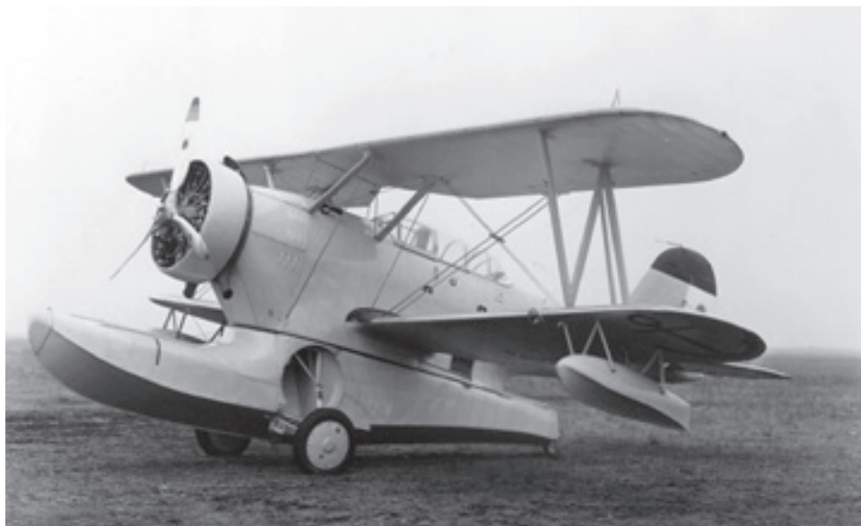
Самолёт-амфибия Grumman J2F Duck с его характерной схемой уборки шасси
