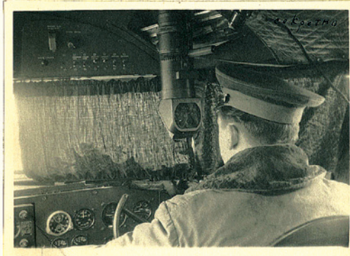
Работа с перископическим прибором, установленным в кабине самолета Ил-12.
