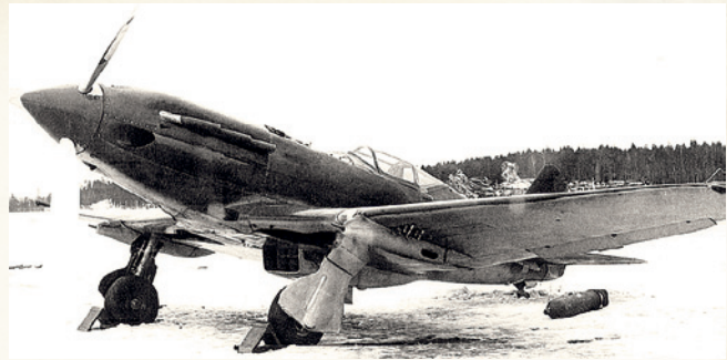
МиГ-3 с подкрыльевыми пулемётами БК на испытаниях
