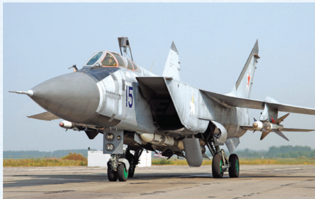
Самолет МиГ-31 с двигателями Д-30Ф6
