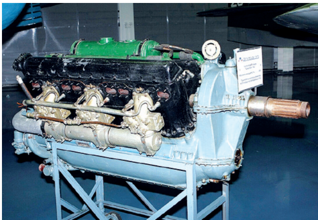
Слева и выше – двигатель М-105. Мотор МБ-100 возник как сочетание двух М-105
