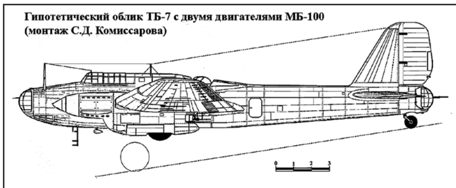
Так мог бы выглядеть бомбардировщик ТБ-7 с двумя двигателями МБ-100 (мотогондолы – условно по типу Ер-2 с МБ-100, с масло- и водорадиаторами в крыле)
