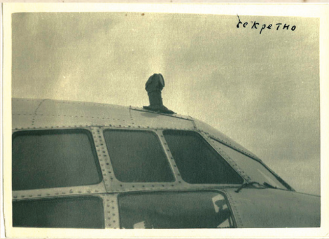
Расположение перископа «Орион» над кабиной Ил-12
