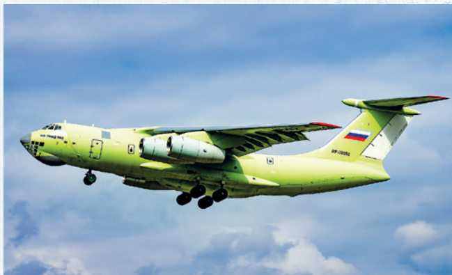
Самолет Ил-76МД-90А с двигателями ПС-90А-76
