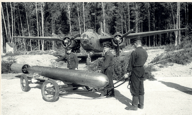
Торпеду 45-36АН с цилиндрическим металлическим стабилизатором готовят к подвеске на самолет А-20Г
