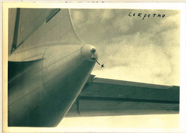
Хвостовой габаритный ИК-огонь Ил-12
