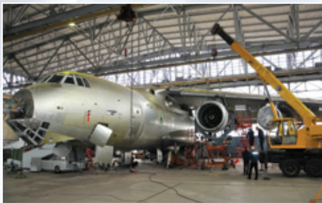
Установка двигателя ПД-14 на крыло самолета Ил-76ЛЛ
