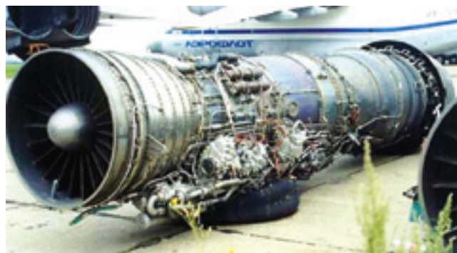
Сердце силовой установки МиГ-31 – двухконтурный форсажный двигатель Д-30Ф-6
