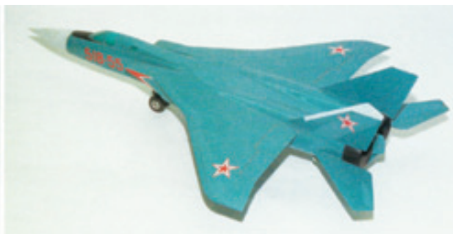
Макеты некоторых проектов, предшественников МиГ-31. Слева – Е-155МП с изменяемой геометрией крыла (1968 г). Справа – проект 518-55 (1971 г). Имеет большое крыло, плавно сопрягаемое с фюзеляжем
