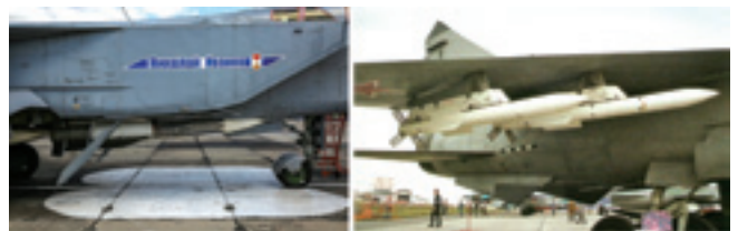
Слева – Ракета К-37 под фюзеляжем МиГ-31М. Одна из таких ракет в 1993 году сбивла мишень на дистанции 220 км. Справа – Ракеты средней дальности Р-77, которые на истребителе МиГ-31 заменили устаревшие ракеты Р-40ТД. Ракеты имеют решётчатые рули
