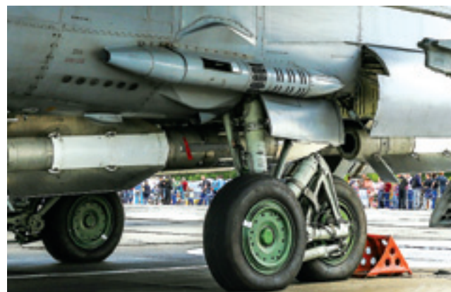
Пушка ГШ-6-23 в правом борту перехватчика МиГ-31 БМ
