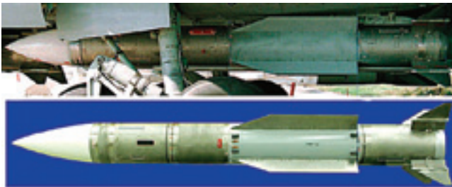
Ракета Р-37 (К-37) имеет тот же калибр и чуть меньшую длину, чем Р-33. Уменьшилось крыло, и оно было сдвинуто вперед, а внешние части стабилизатора сделали стреловидными
