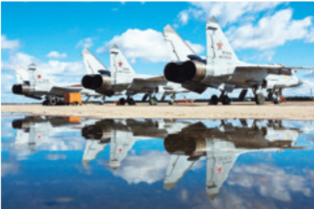
Перехватчики МиГ-31БМ на аэродроме. Обратите внимание на подкрыльевые пилоны для ракет средней дальности Р-77 у самолёта на переднем плане. У других самолётов – другие пилоны
