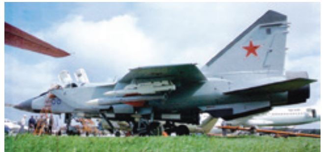
Самолёт с бортовым номером «58» был первым истребителем, модернизированным в вариант МиГ-31БМ. На этом фото самолёт кроме ракет воздушного боя несёт ракеты класса «воздух-земля», в частности – противорадиолокационные ракеты Х-58 под крылом
