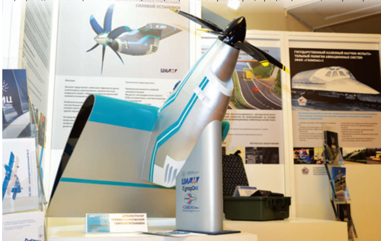
Макет части гибридной силовой установки представляет собой фрагмент крыла и мотогондолу с электроприводным винтом с оборудованием на основе эффекта высокотемпературной сверхпроводимости
