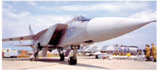
Этот МиГ-31М является последним из семи прототипов конца 80-х годов XX века, которые не пошли в производство. Истребитель получил более мощный радар Заслон-М и ракеты К-37
