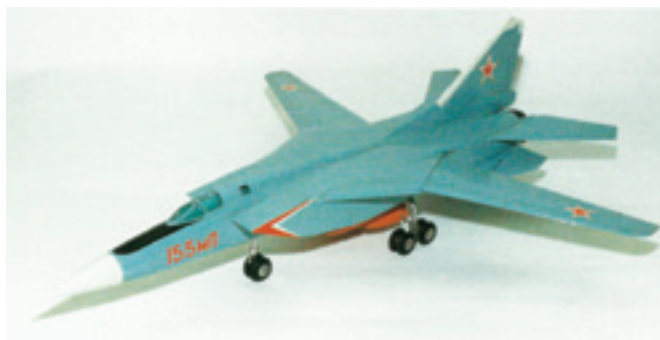
Макеты некоторых проектов, предшественников МиГ-31. Слева – Е-155МП с изменяемой геометрией крыла (1968 г). Справа – проект 518-55 (1971 г). Имеет большое крыло, плавно сопрягаемое с фюзеляжем
