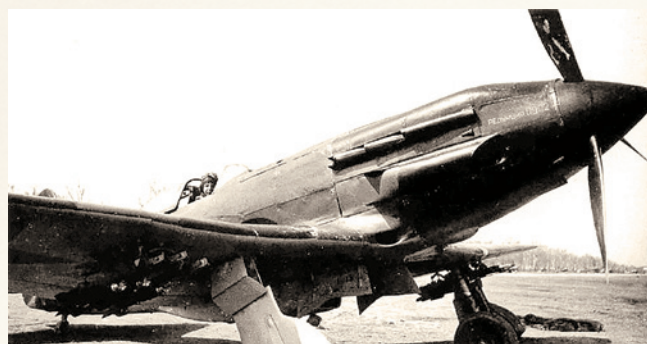
Истребитель МиГ-3 с двумя установками ЗРОБ-82 под консолями крыла
