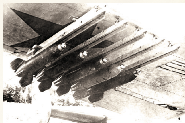
Реактивные снаряды РОФС-132 под крылом бомбардировщика Пе-2
