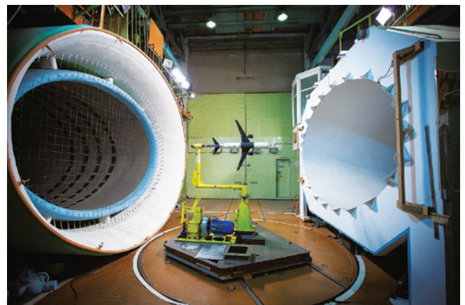
Отработка систем управления гражданского самолета в дозвуковой аэродинамической трубе ЦАГИ
