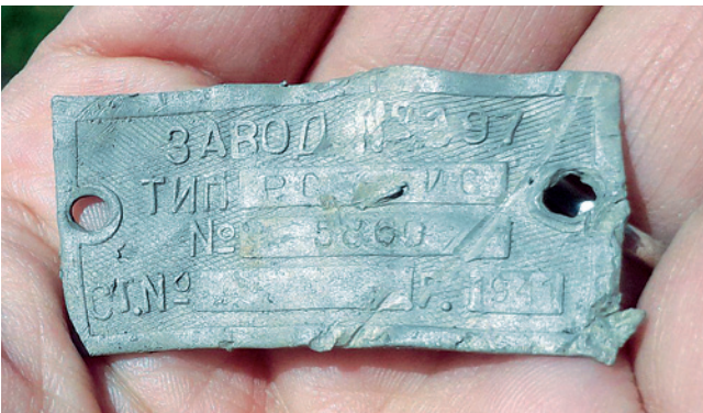
Шильда от передатчика радиостанции. Завод 197. Тип РСБ-бис. № 5860. 1941 год
