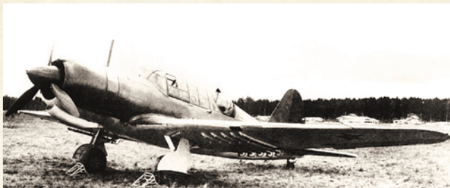
Ближний бомбардировщик Су-2 с десятью реактивными орудиями РО-82
