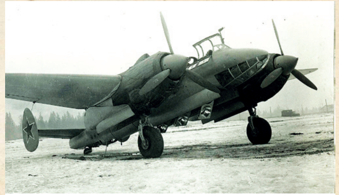
Самолет Ту-2с с установкой «Явор». Проектор откинут для перезарядки нити.
