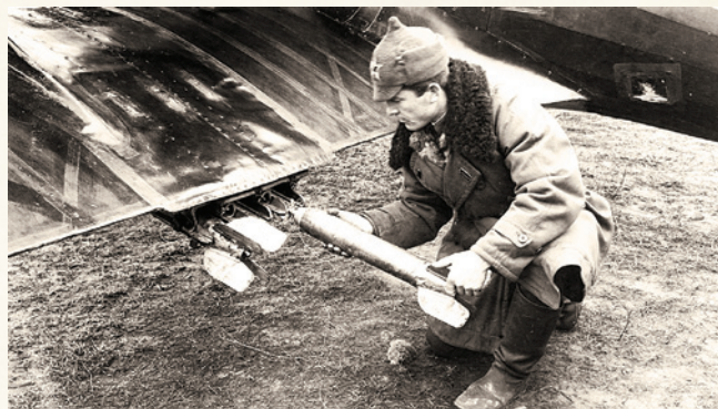
Снаряжение ракетных пусковых установок самолета P-5 снарядами РС-82
