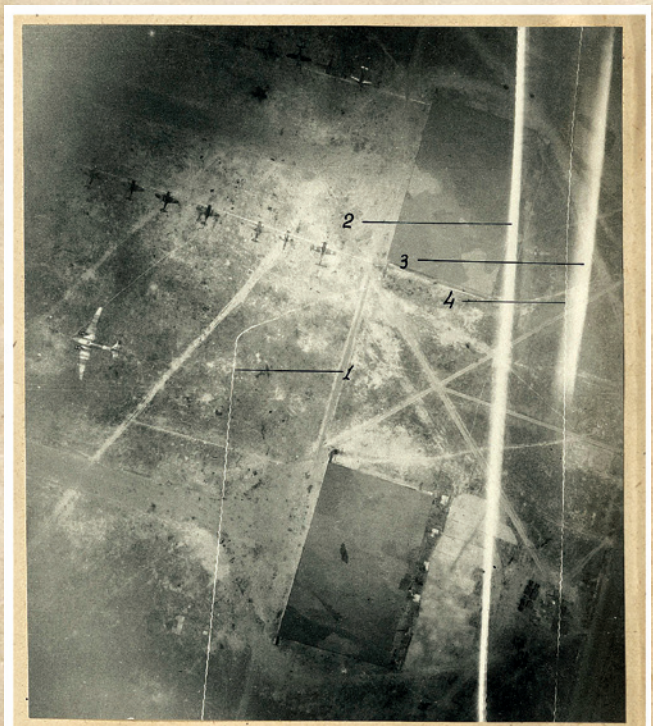
Ночной аэроснимок, выполненный установкой «Явор» без синхронизирующего устройства. H=600\text{м} . 1,2,3,4 - следы наземных огней, отпечатавшиеся на аэропленке вследствие отсутствия затвора в аэрофотоаппарате.
