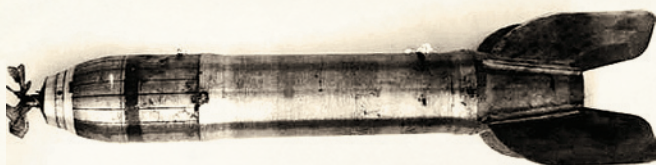
Реактивный снаряд РС-82, снаряженный дистанционной трубкой
