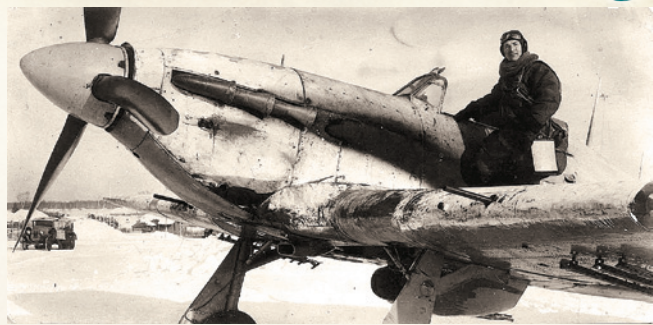
Реактивные снаряды РС-82 в рамках программы перевооружения получил даже английский истребитель «Харрикейн»
