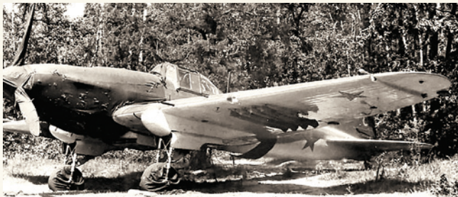
Одноместный штурмовик Ил-2 с восемью ракетными орудиями УРО-82
