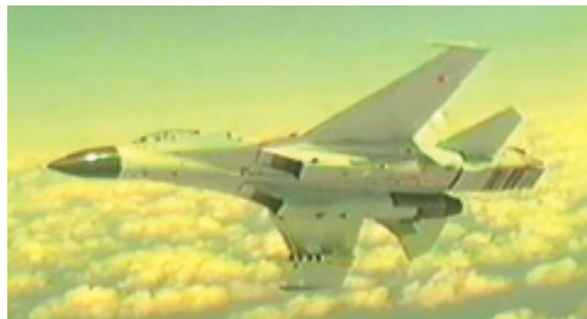
Летающая лаборатория Су-27ЛЛ с опытным плоским соплом
