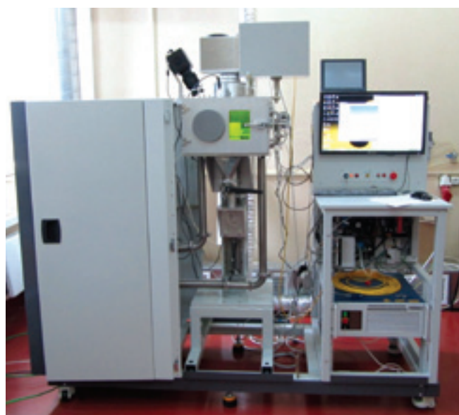
Экспериментальная установка МЛ 6 для селективного лазерного сплавления
