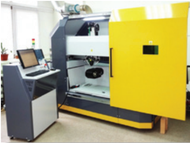
Лазерный станок СЛ 5-150 для обработки керамических стержней
