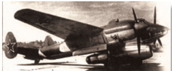
Летающая лаборатория Ту-2ЛЛ с опытным двигателем РД-45
