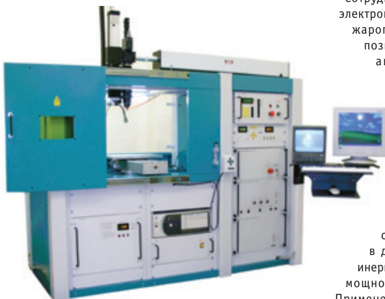
Экспериментальная установка МЛ 6 для селективного лазерного сплавления
