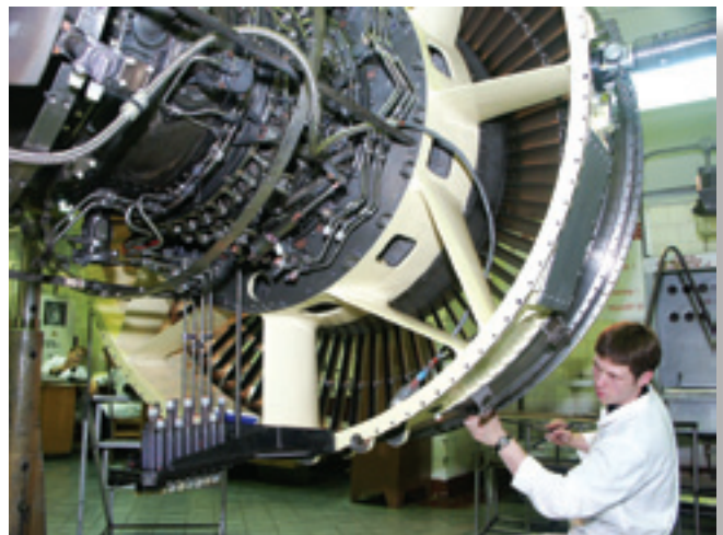
Сборка двигателя ПС-90А
