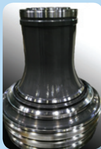
Сварная конструкция ротора КВД
