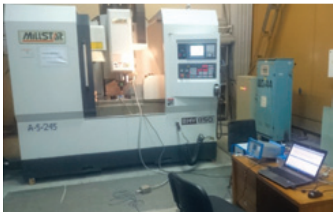
Диагностический стенд для исследования процесса фрезерной обработки
