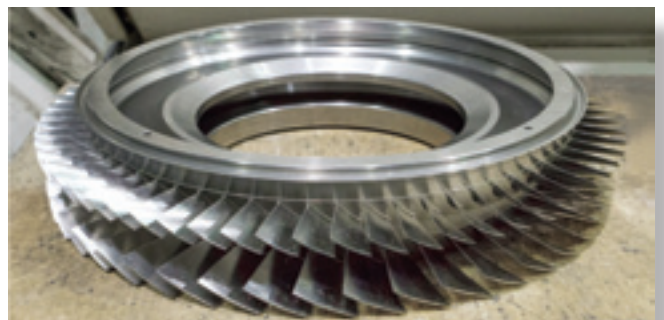
Рабочие моноколеса КВД, сваренные ЭЛС
