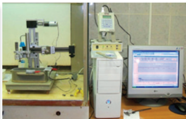
Автоматизированный комплекс определения поверхностных остаточных напряжений МеркулОН «Тензор-3»
