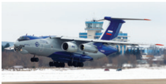
Летающая лаборатория Ил-76ЛЛ с опытной двигательной установкой ДУ ПД-14
