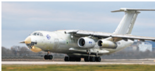
Взлет самолета Ил-76ЛЛ с двигателем ПД-14
