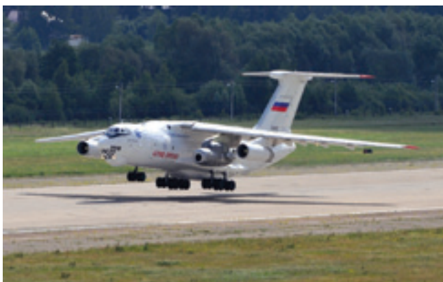
Летающая лаборатория Ил-76ЛЛ с опытным двигателем «Kaveri»
