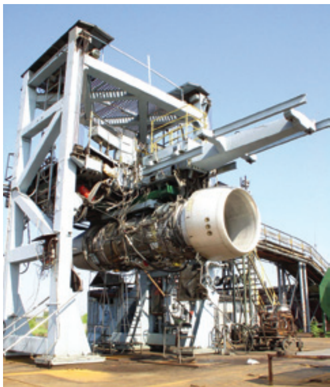
Двигатель Д-30КУ-154 на испытательном стенде
