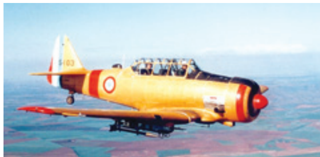
Чтобы облегчить поиск сбитых или совершивших аварийные посадки «Тексанов», французы обычно красили их в ярко-желтый цвет с красными полосами вокруг фюзеляжей и такими же законцовками крыльев. Под крылом этого штурмовика хорошо виден контейнер с двумя пулеметами и неуправляемый реактивный снаряд T-10
