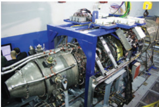
Аппаратура НПП «МЕРА» на стенде испытаний авиадвигателей
