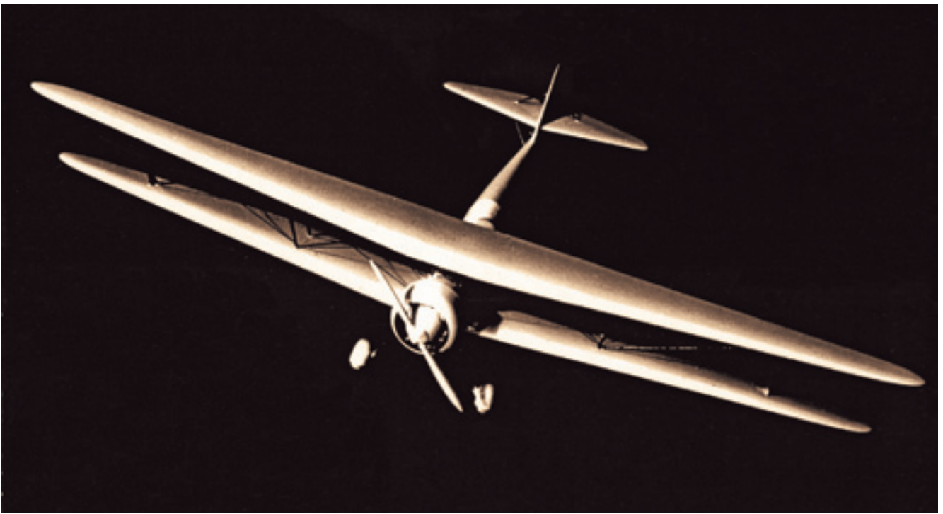
Модель СБ-1 (Р-В) – вид спереди сверху. Видны подкосы хвостового оперения, отсутствующие в чертежах к эскизному проекту
