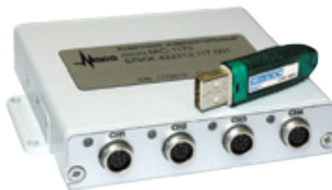
Комплекс МІС-1170, предназначенный для построения распределенных измерительных систем
