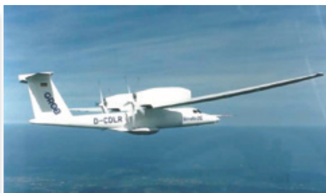
Экспериментальный самолёт Grob Strato 2C – обладатель мирового рекорда высоты для самолётов с поршневыми двигателями
