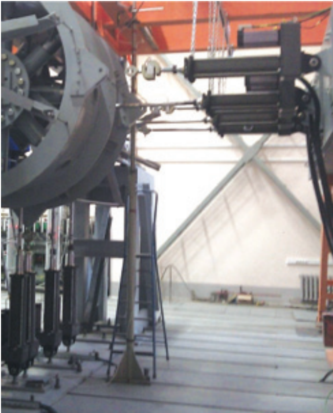
Стенд статических испытаний с электромеханическими устройствами нагружения
