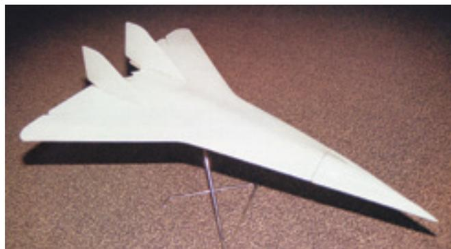
**Модель самолета одного из первых проектов по теме Ту-160 (самолет с крылом изменяемой стреловидности)**
