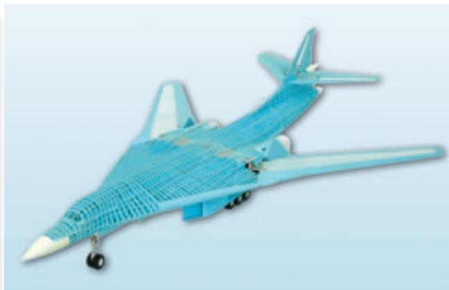
**Модель самолета, представляющая силовую конструкцию одного из проектов по теме Ту-160 с вертикальным расположением двигателей**
