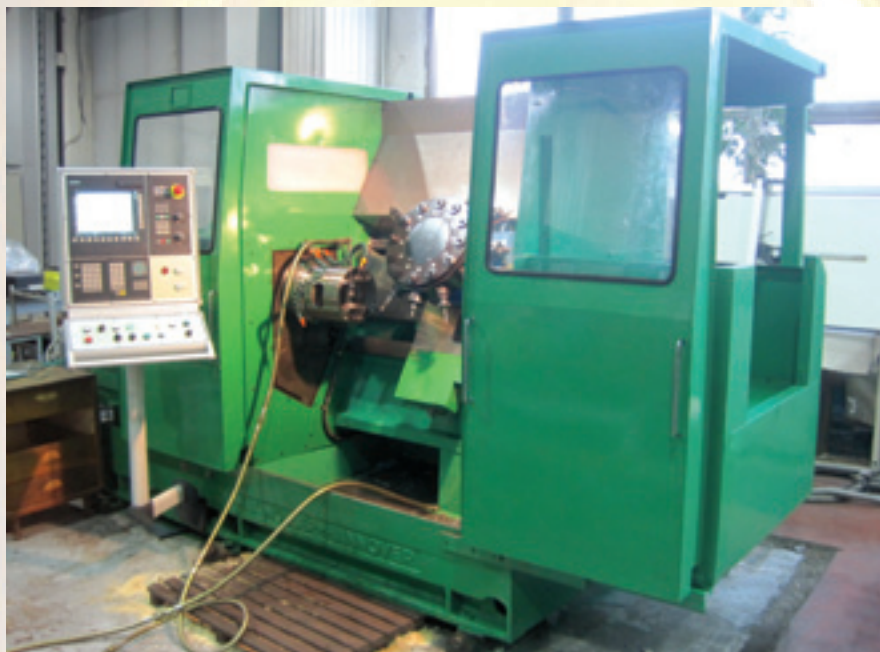
Токарный полуавтоматический станок с индексным патроном для обработки трубопроводной арматуры МТ-10И
