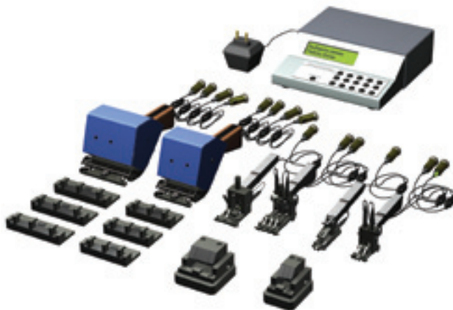
Прибор для контроля площади проходных сечений сопловых аппаратов мод. БВ-7631
