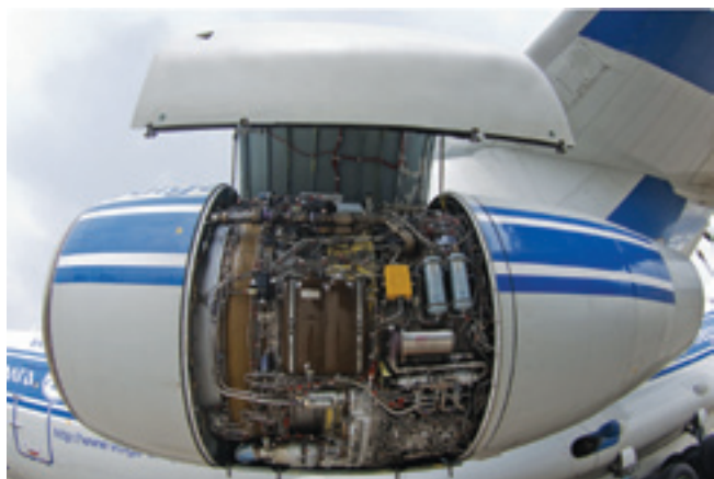
Двигатель PS-90A-76 на крыле уникального «воздушного грузовика» Ил-76ТД-90ВД
