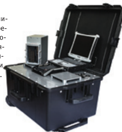
Новая разработка – переносная станция НАСКД-200ПР для проверок на борту вертолетов разных типов
