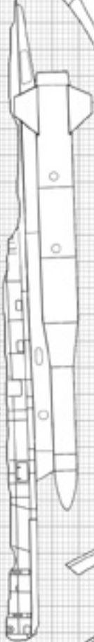
ПОДВЕСКА РАКЕТЫ W3-109С НА ПОДМОТОРНОМ ПИЛОНЕ
