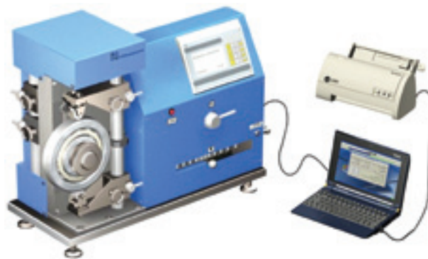
Прибор для контроля радиальных зазоров подшипников мод. БВ-7660»
