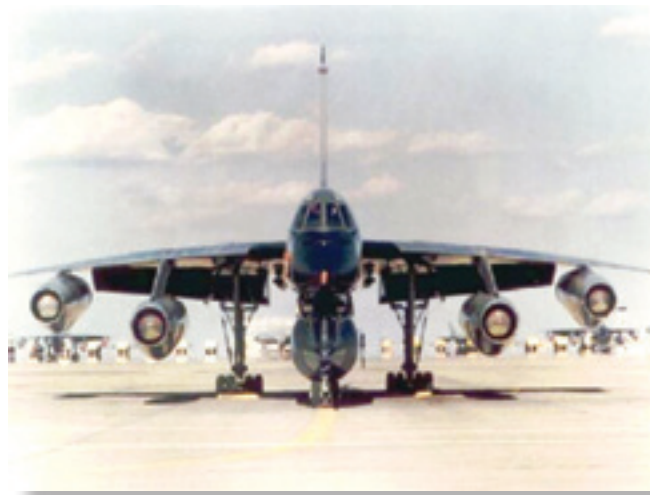
У полностью заправленного В-58 крылья немного опустились вниз
