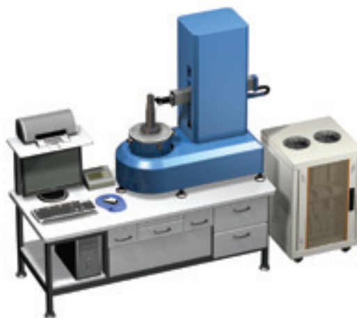
Прибор ультрапрецизионный для измерения отклонений от круглости, цилиндричности, плоскостности и шероховатости поверхностей осеблочных деталей мод. БВ-2047
