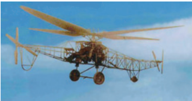
Вертолет ЦАГИ 1-ЭА – очевидно внешнее сходство этого вертолета (1930 г.) и вертолета И.И.Сикорского (1942 г.)
