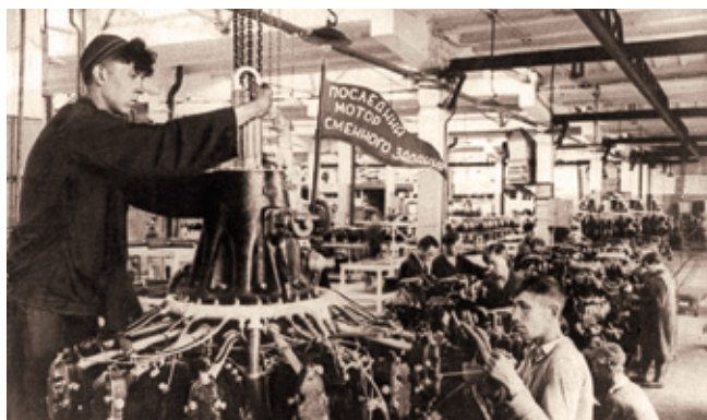
Сборка мотора АШ-82 для истребителя Ла-5, 1942 г. ЦИАМ сыграл большую роль в доводке этого двигателя
