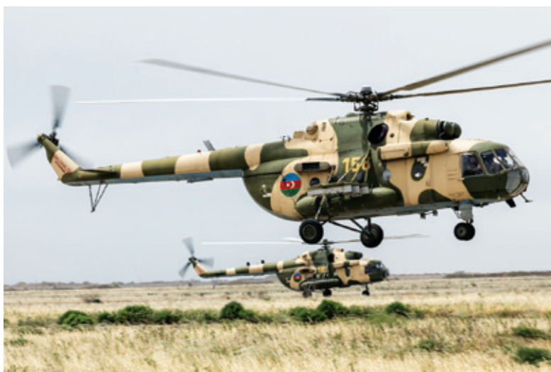
Вертолёты Ми-17-1В ВВС Азербайджана, оснащённые балками для подвески оружия
