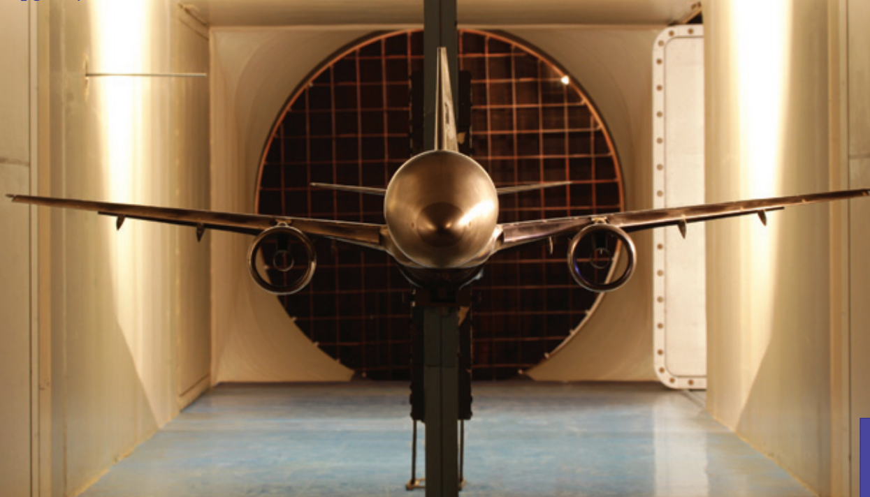
Испытание модели ближне-среднемагистрального самолета МС-21 в трансзвуковой аэродинамической трубе ЦАГИ
