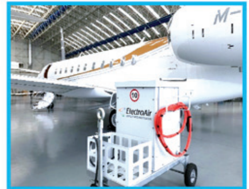
Аэродромные источники питания переменного напряжения 200В 400Гц и постоянного тока 27В
