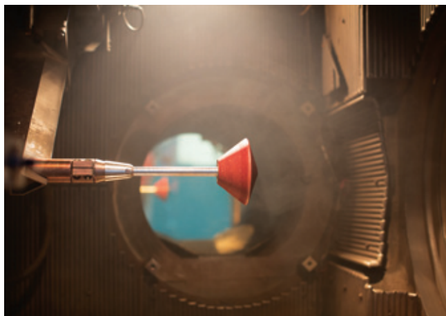
Испытание десантного модуля проекта ExoMars в гиперзвуковой аэродинамической трубе ЦАГИ
