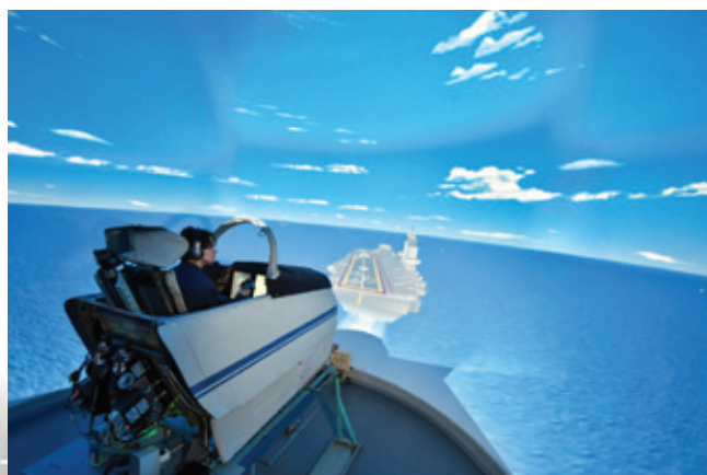
Пилотажный стенд для отработки динамики маневренных самолетов
