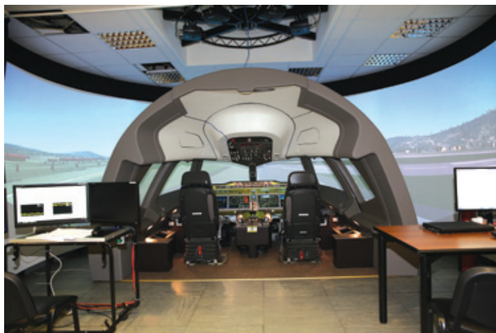
Стенд отработки человеко-машинного интерфейса кабины самолета MS-21
