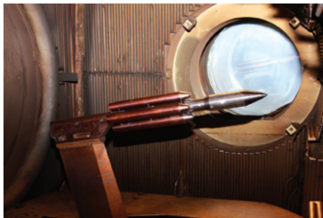
Испытание ракеты-носителя «Ангара» в гиперзвуковой аэродинамической трубе ЦАГИ
