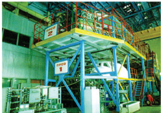
Рисунок 8. ПРСО – полноразмерный стенд оборудования
