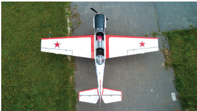
Серийный Як-52 со «срезанными» законцовками крыла
