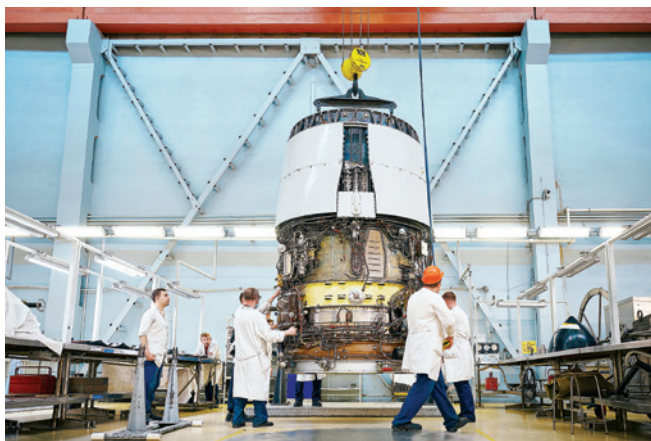
Турбовентиляторный двигатель четвертого поколения для гражданской, транспортной и специальной авиации ПС-90А
