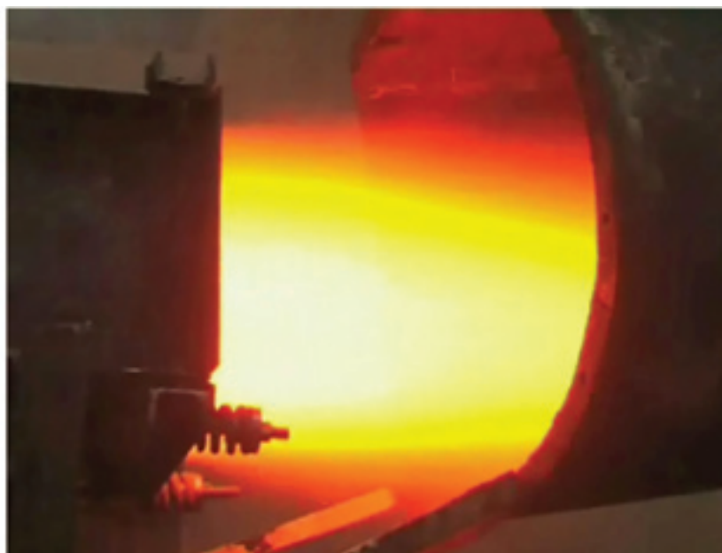
Рис. 1. Испытания камеры сгорания гиперзвукового прямоточного воздушно-реактивного двигателя на исследовательском стенде МАИ
