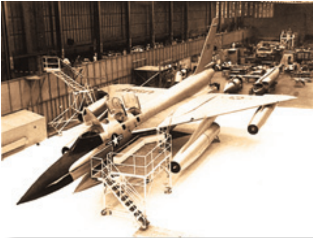
Полномасштабный макет бомбардировщика МХ-1964 «Конфигурация III». Под фюзеляжем подвешен макет контейнера МА-1. Август 1954 года
