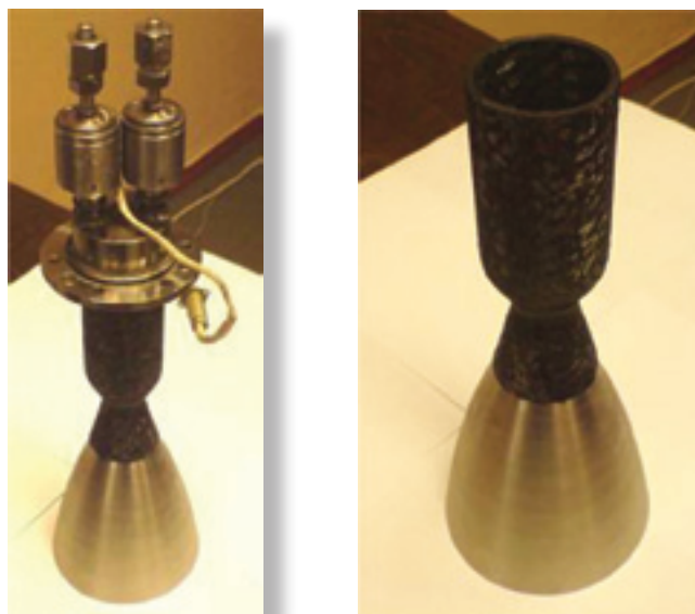
Рис.4. Разработанные в МАИ экспериментальные ЖРД тягой 200 и 500Н с композиционной камерой сгорания
