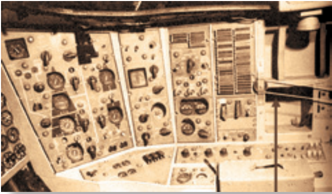
Правый борт кабины летчика. За панелью световой сигнализации видна бельевая веревка и шкив «системы взвода ядерного оружия»
