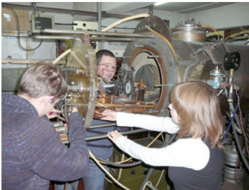
Рис.5. Испытания разработанных в МАИ плазменных электроракетных двигателей и подготовка студентами факультета вакуумной камеры к испытаниям
