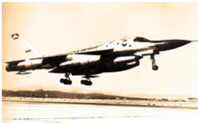
Взлетает В-58 55-665 Споору с установленным радиолокатором от перехватчика F-12А. Под внешними двигателями подвешены контейнеры с кинокамерами
