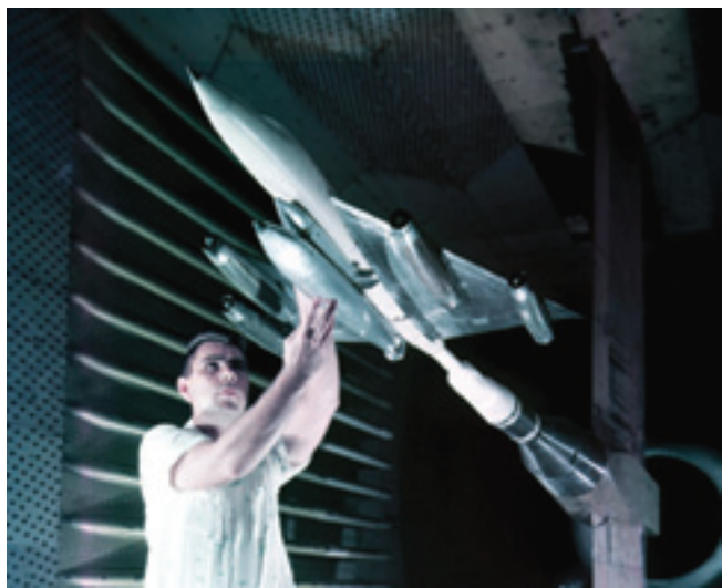
Продувочная модель бомбардировщика B-58. Исследуется один из вариантов двухкомпонентного контейнера ТСП
