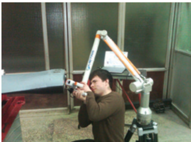
Рис.2. Метрологический контроль модели гиперзвукового ЛА до и после испытаний гиперзвуковой трубе ЦИАМ
