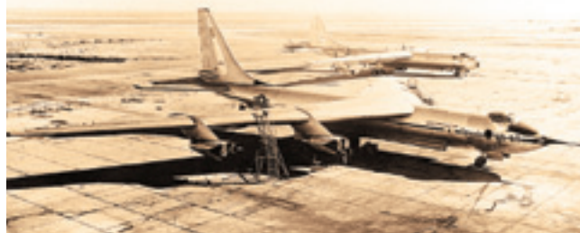
Самолёты YB-60 (на переднем плане) и B-36 были самыми крупными самолётами в то время и являлись главными кандидатами на установку атомного двигателя
