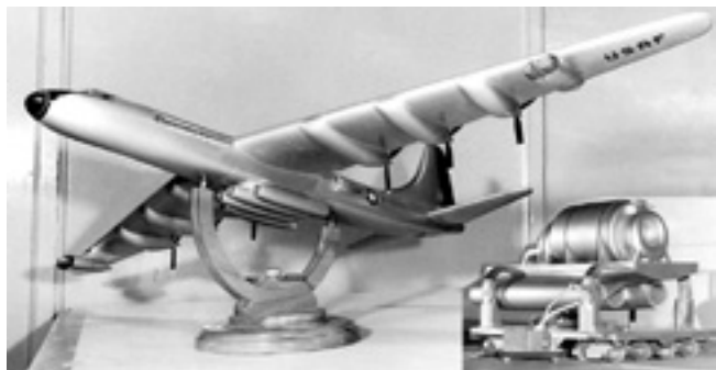
Модель самолёта B-36, снабжённого атомной силовой установкой P-1. Установка P-1 на тележке обслуживания показана на врезке справа
