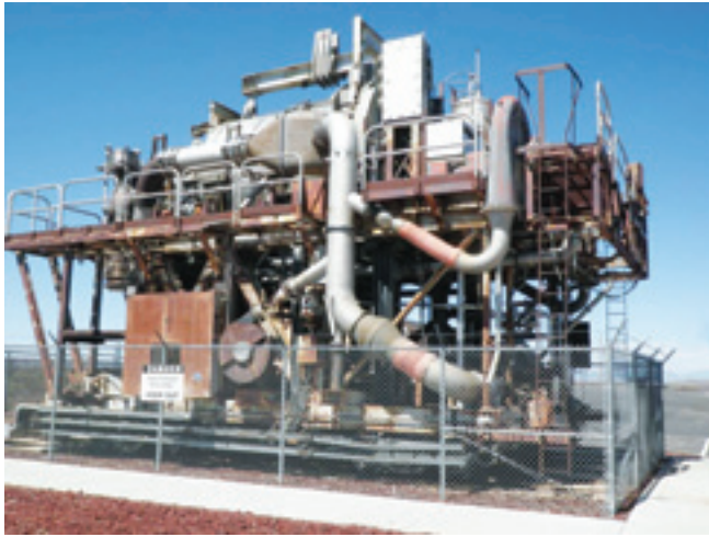
Установка HTRE-3. Сверху - горизонтальный реактор. На переднем плане - вспомогательные воздухопроводы и трубопроводы холодного воздуха. Реактивные двигатели должны были стоять справа, внизу. Сейчас они отсутствуют
