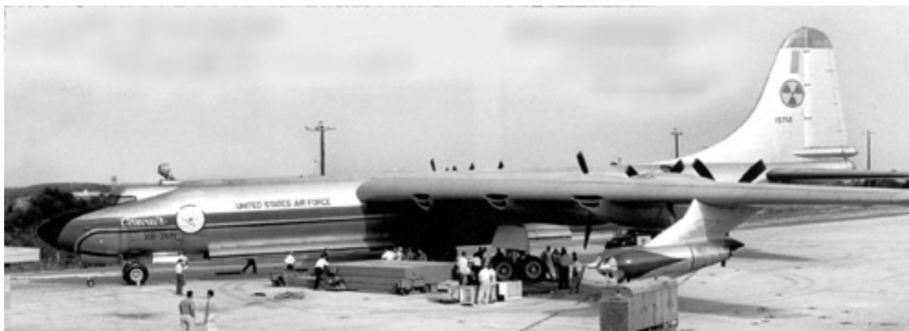
«Атомный» самолёт NB-36H. На фюзеляже написано XB-36H, надпись NB-36H появилась позже. Обратите внимание на толщину аварийного люка, открытого наверху кабины. На киле стоит знак радиационной опасности. За носовой стойкой шасси открыты створки входного люка. Створки бомболюка так же открыты
