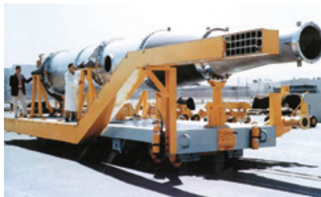
ЯПВРД «Тори II-C» монтируется на ЖД платформе. Подача воздуха - справа. В 1964 на площадке «Плутто» в Невадском ядерном полигоне, «Тору II-C» работал на полной тяге в течение 5 минут
