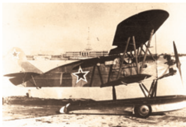
Испытание самолета У-2 на поплавах на Химкинском водохранилище, 1939 г.
