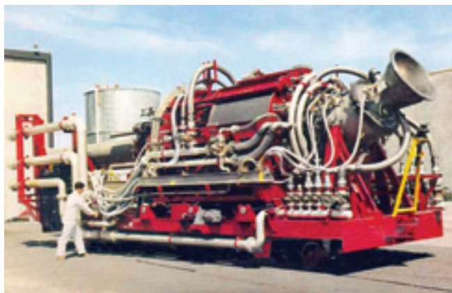
ЯПВРД «Тори II-A», смонтированный на ЖД платформе. Сопло (справа) - отклонено вверх. Три белые трубы по левому борту служат для подачи охлаждающей воды. 14 мая 1961, на площадке «Плутто» в Невадском ядерном полигоне, он впервые в мире отработал несколько секунд
