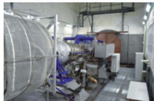
**Двигатель Д-30Ф6 на стенде**
