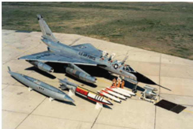
**B-58 с вооружением. Нижняя часть контейнера ТСР, верхняя часть контейнера ТСР, четыре ядерные бомбы Mk.43, хвостовая стрелковая установка и 1200 снарядов**
