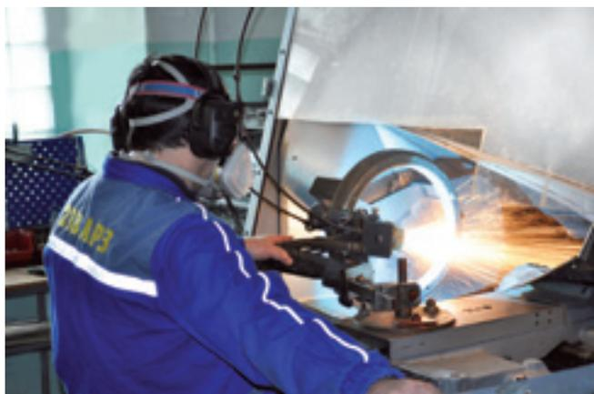
Установка газоплазменного напыления
