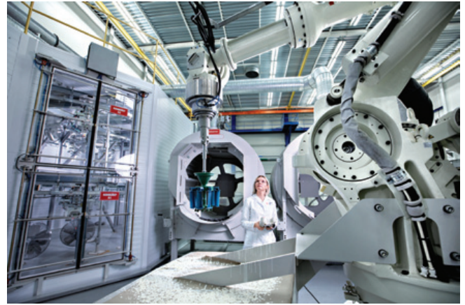
Роботизированная линия нанесения огнеупорных покрытий и получения керамических огнеформ для заливки методом направленной кристаллизации лопаток. Литейный цех ПАО «ОДК-Сатурн»
