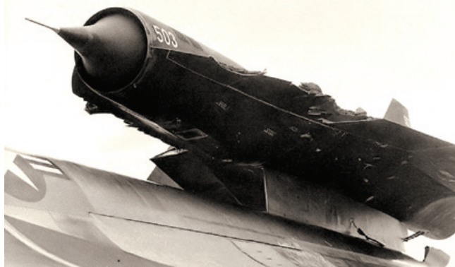
Результат первого неудачного запуска аппарата D-21
