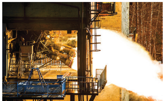
Испытание ракетного двигателя РД-107А на стенде ПАО «ОДК-Кузнецов»
