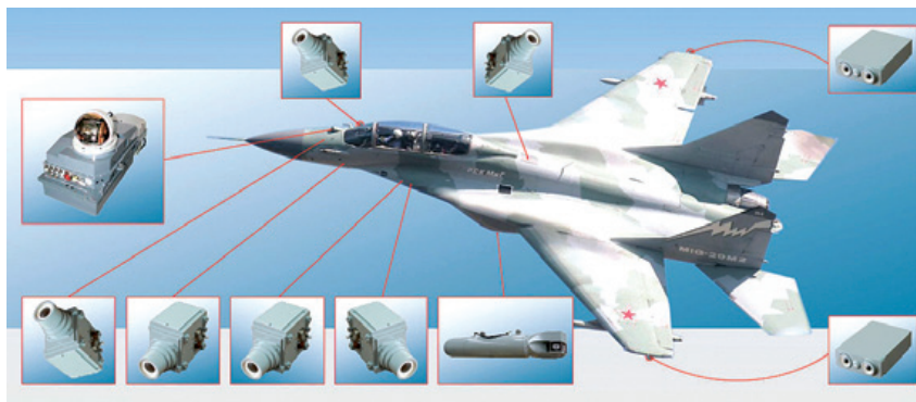
Опто-локационное оборудование, устанавливаемое на самолёт МиГ 29М/М2 - опто-локационная станция (ОЛС)
