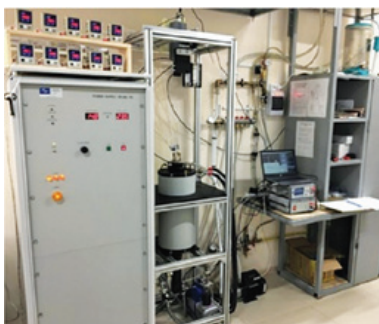
Внешний вид установки для калибровки высокотемпературных термопреобразователей
