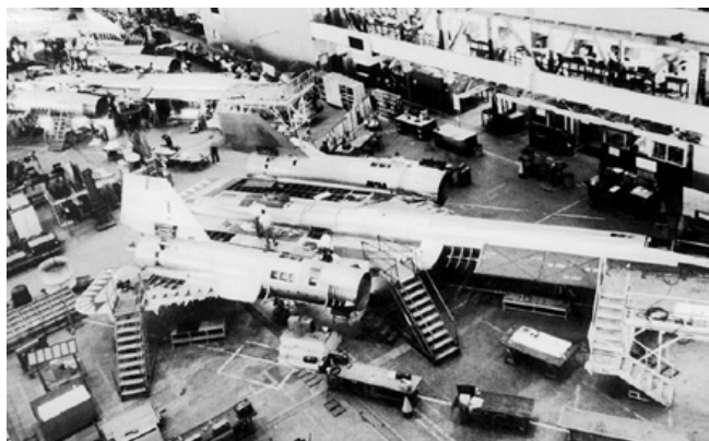
Сборка самолетов А-12 на заводе фирмы Lockheed в Бербанке
