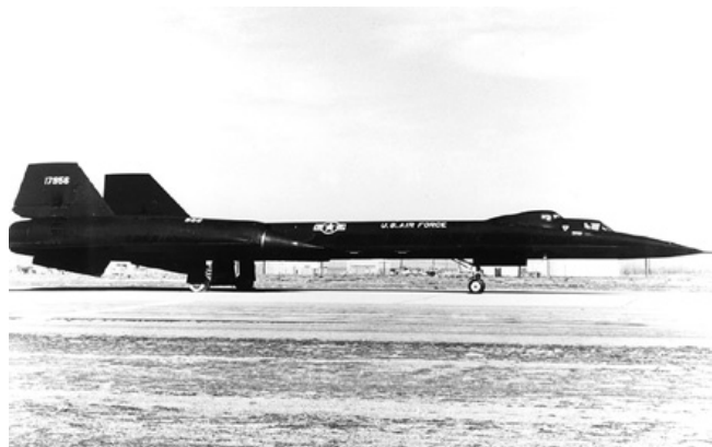
Двухместный самолет SR-71B. В основном использовался NASA для высокоскоростных испытаний под обозначением NASA 831. Налетал около 3500 летных часов
