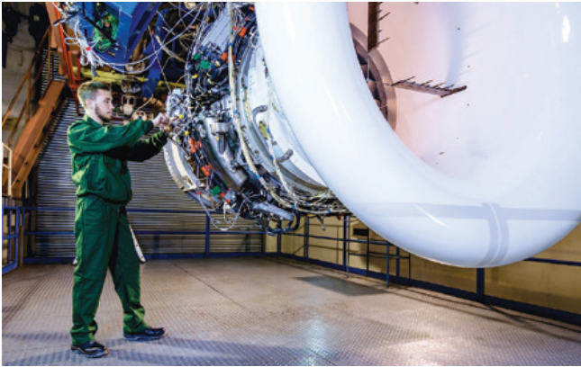
Первый опытный двигатель ПД-8 на испытательном стенде ПАО «ОДК-Сатурн»
