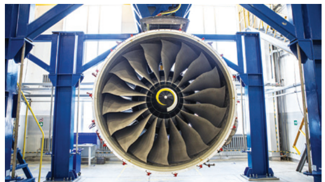
ПД-14 в зале подготовки к испытаниям
