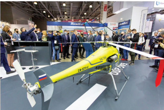
БАС-200 – беспилотный летательный аппарат вертолетного типа
