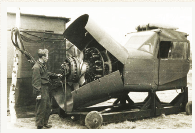
Установка генератора с мотором АИ-14 в носовой части самолёта Як-12Р
