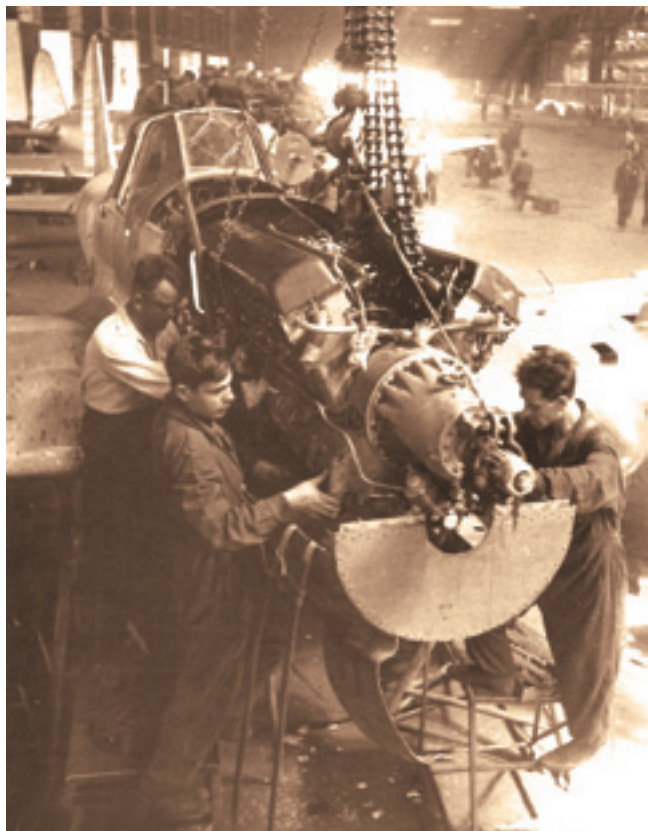
Монтаж мотора АМ-38 на штурмовик Ил-2
