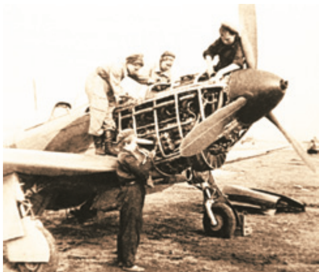
Прошедшие ремонт моторы М-105 обрели вторую жизнь на боевых самолетах Як-1
