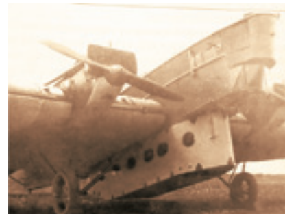
16-местная кабина подфюзеляжная КП-1 под фюзеляжем ТБ-1
