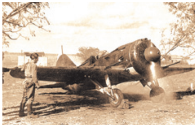
Отремонтированный самолёт проходит гонку мотора
