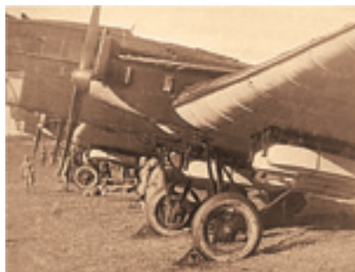
Автоматические «люльки» Гроховского под крылом ТБ-1
