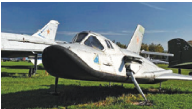
Изделие 105-11 - экспериментальный пилотируемый орбитальный самолет ОКБ «МиГ»
