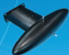
Система измерения воздушных параметров вертолета для Ка-52
