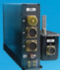
Система измерения высотно-скоростных параметров для Су-35
