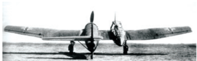
На фото хорошо виден асимметричный стабилизатор, применяемый на самолётах BV 141 В
