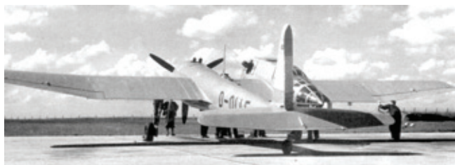
Самолёт BV 141 A-01 с гражданским обозначением D-OLLE имел симметричный стабилизатор, громоздкую кабину экипажа и выхлопные патрубки над капотом мотора
