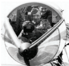
Хвостовой конус кабины экипажа раскрывался. Кормовой стрелок держит в руках кинокамеру, а может взять и пулемет
