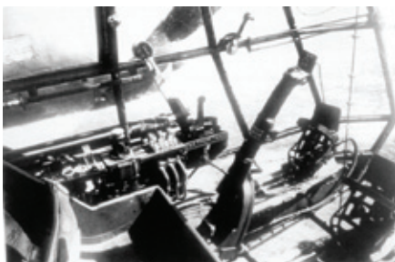
Вид на левый борт кабины пилота. Приборы контроля силовой установки были вынесены на капот мотора. (Верхняя левая часть снимка)
