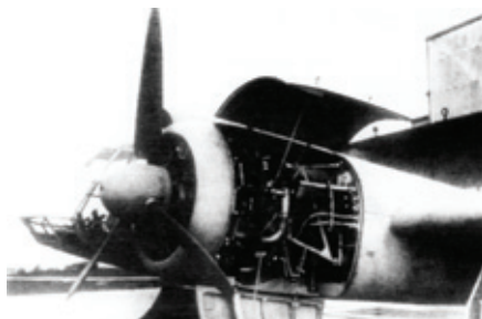
BV 141 V3 имел девятицилиндровый звездообразный мотор BMW 132 N
