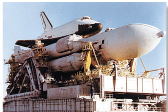
Универсальная космическая система «Энергия – Буран», на которой были установлены малоразмерные двигатели РТВД-14 и ТП-22 конструкции ОКБ им. А.М. Люльки, 1988 г.
