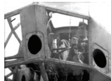
Носовое остекление BV 141. На переднем плане торцы фальшстволов пулемётов. В глубине виден пилот
