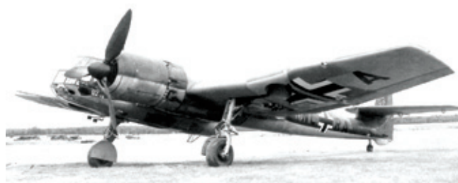
Самолёт BV 141 В (NC+RA). На передней кромке левого крыла видна фара. Под правым крылом видны противоблужетные грузы элерона
