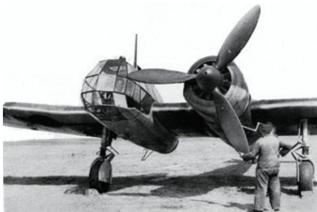
Мотор BMW 801, мощностью 1560 л/с, был силовой установкой самолётов BV 141 В
