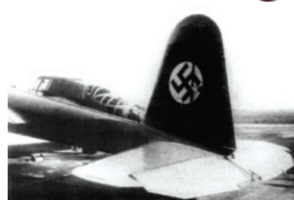
Самолёт BV 141 V3 имел симметричный стабилизатор
