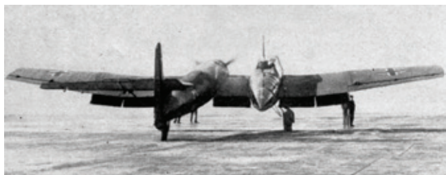
Самолёт BV 141. Посадочные щитки выпущены
