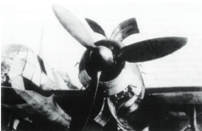
Мотор BNW 801 А-0, максимальной мощностью 1560 л/с, устанавливался на самолёты BV 141 В
