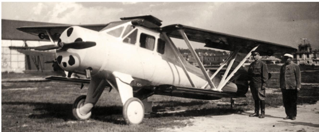
**В.С.Пышнов демонстрирует складывание консолей крыла самолета ВВА-1**
