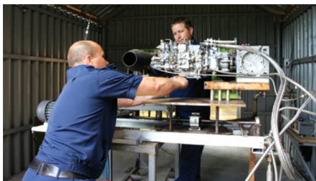
**Подготовка к огневым испытаниям насоса-регулятора НР-2500 вертолета Ми-28НМ на стенде Огневая труба**
