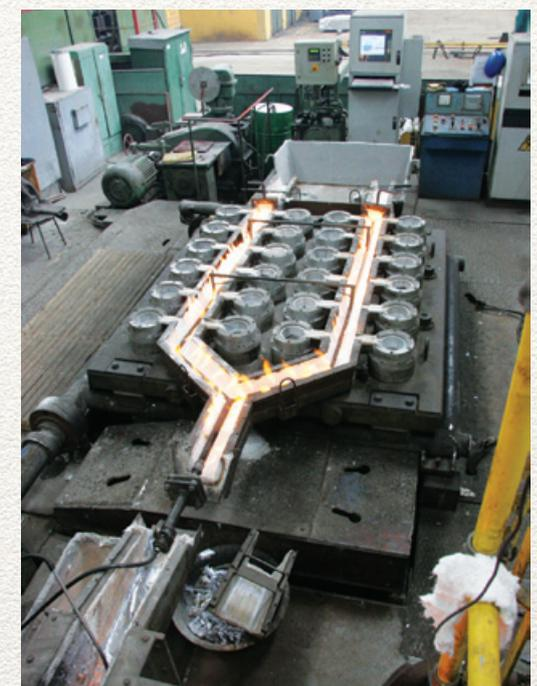
**Многокристаллизаторная установка для литья круглых слитков, установлена в 2001 году**
