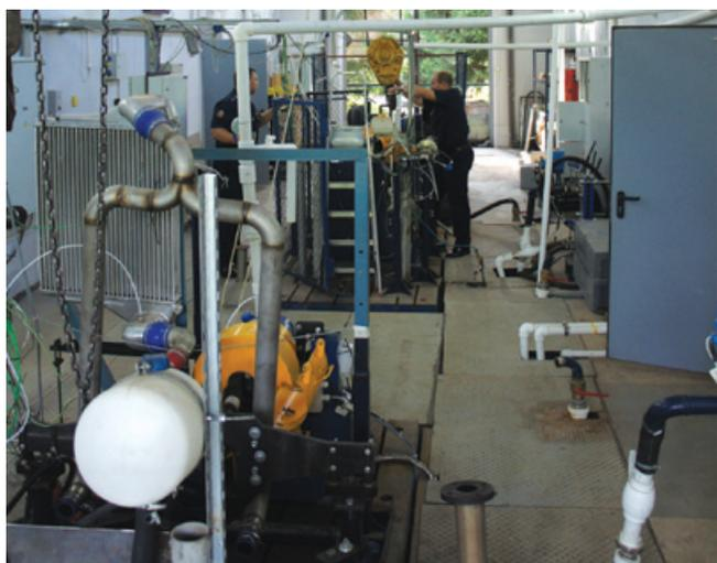
**Подготовка рабочей установки РУ-5 к испытаниям поршневого двигателя АПД-250/300 разработки АО ГМЗ «Агат»**
