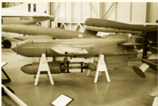
Управляемая ракета Hs 293 в музее английских Королевских ВВС. Обтекатель двигателя Вальтера снят, можно рассмотреть камеры, в которых происходило разложение перекиси водорода в присутствии катализатора. Горячие продукты разложения (кислород и водяной пар) создавали тягу двигателя
