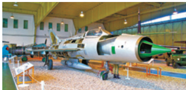
Препарированный МиГ-21ПФ в «исторической» экспозиции. Створки окон дополнительного забора воздуха выкрашены радиопрозрачной краской, видимо, для красоты
