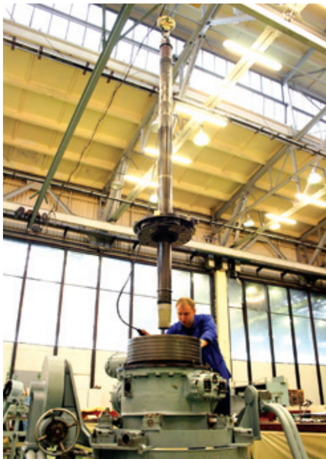
Сборка редуктора вертолета соосной схемы
