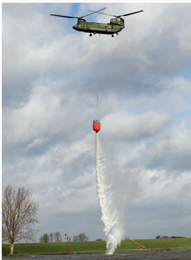
Вертолёты «Чинук» на пожаротушении. Вверху – полёт с ВСУ, внизу – слив воды на условный очаг пожара
