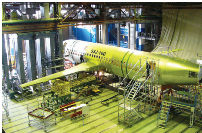
Прочностные испытания регионального самолета нового поколения Superjet 100 в зале статических испытаний ЦАГИ
