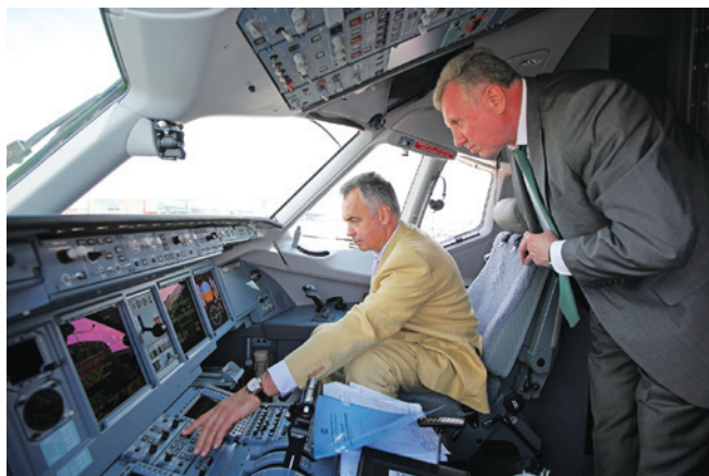
SSJ100 – первый в России самолет с «пассивной» боковой ручкой и «активными» рычагами управления двигателем, а не штурвалом
