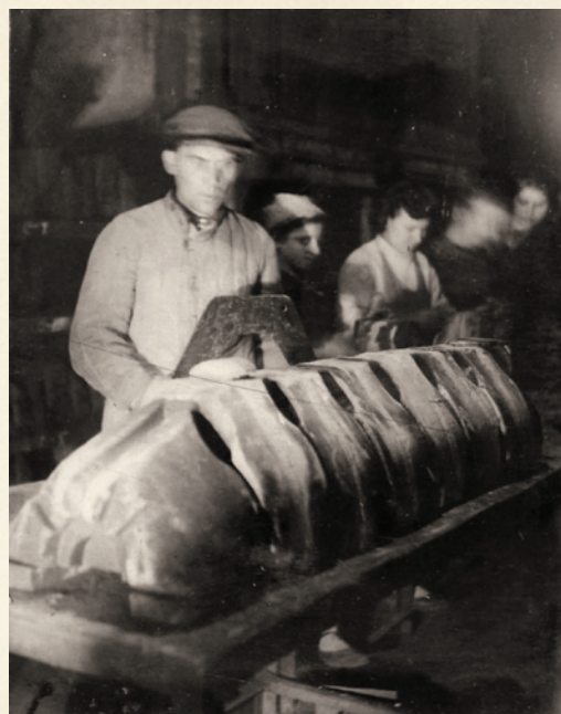
Сборка формы нижнего картера в литейном цехе. 1943 год
