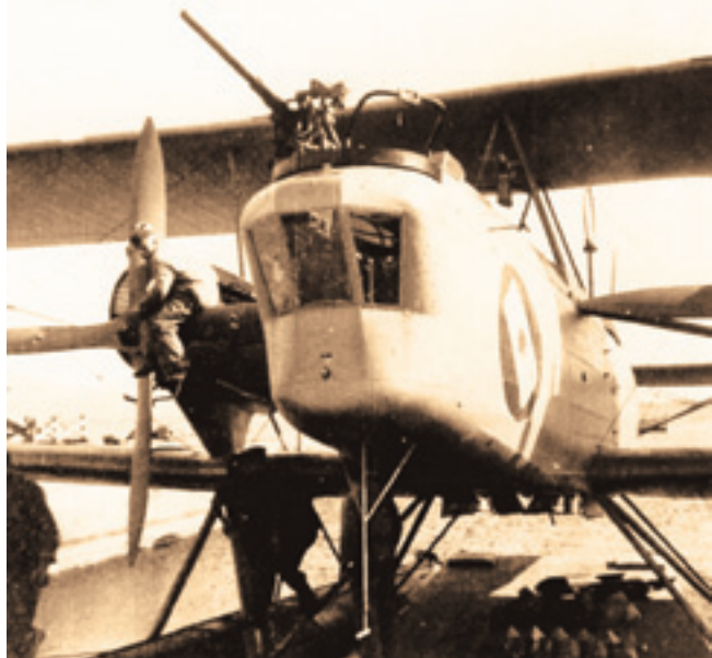
Установка пушки Rheinmetall - Borsig (Oerlikon) MG-FF калибра 20 мм на турели в кабине штурмана
