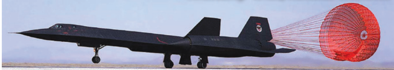
SR-71 касается полосы. Тормозной парашют уже выпущен
