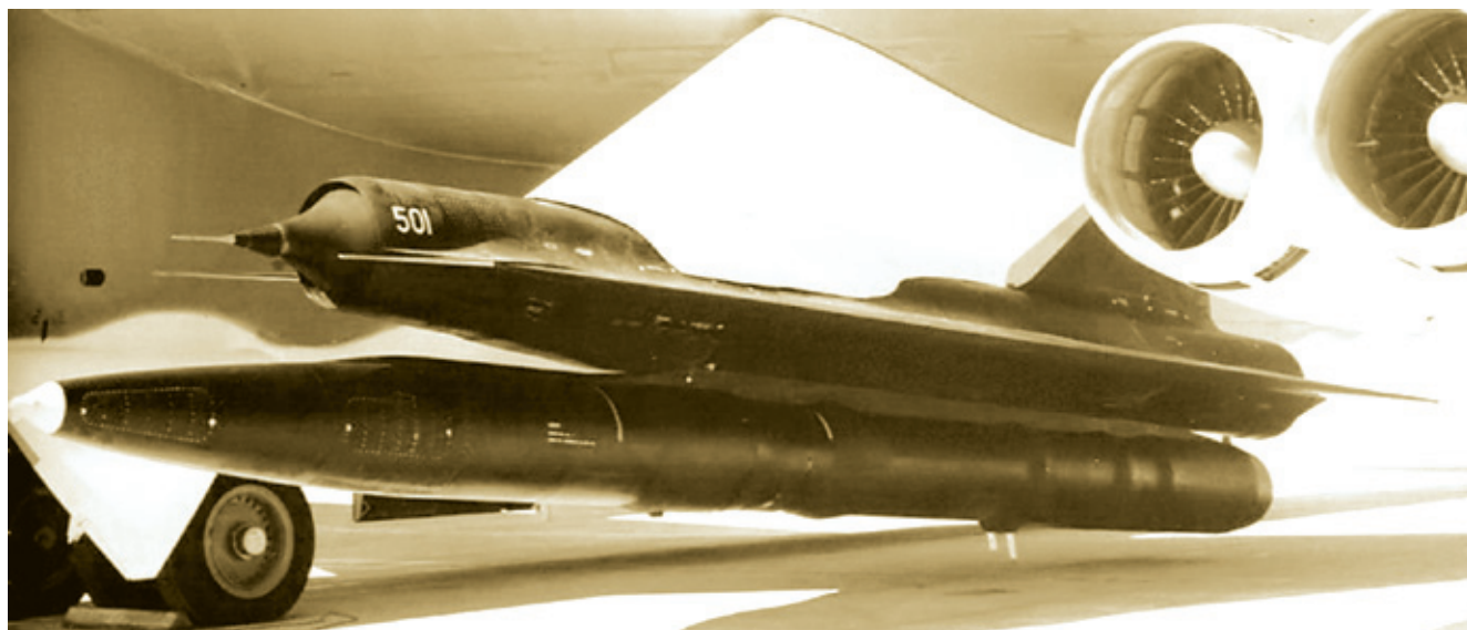
D-21V со стартовым ускорителем подвешенный под крыло бомбардировщика B-52H
