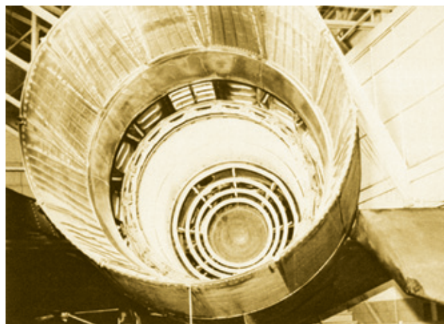
Сопло SR-71 и стабилизаторы горения форсажной камеры
