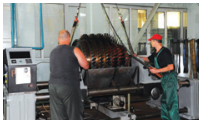
Балансировка ротора компрессора после ремонта
