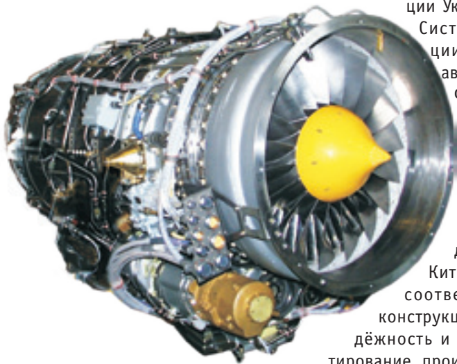
AI-222-25 - турбореактивный двухконтурный двигатель для учебно-боевых самолетов
