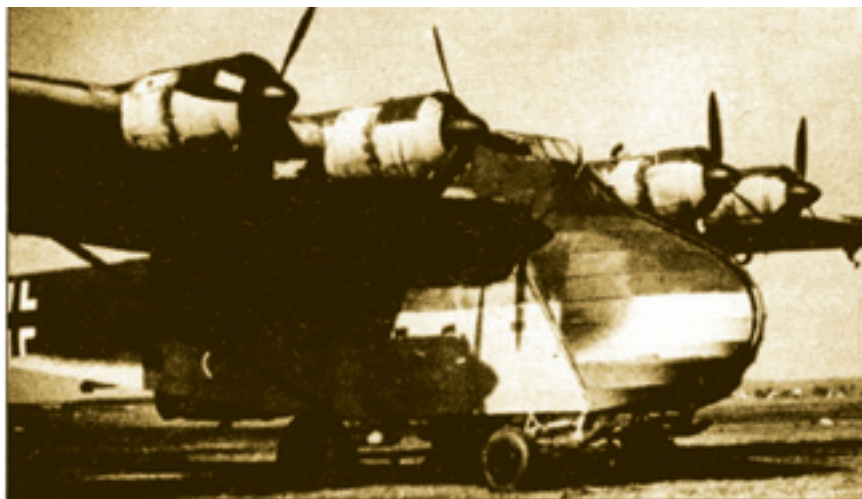
Следующий шаг – установка на планер двигателей. Так появился Me 323V-1. В дальнейшем число двигателей возросло до 6, и появился самолёт Me 323 Гигант
