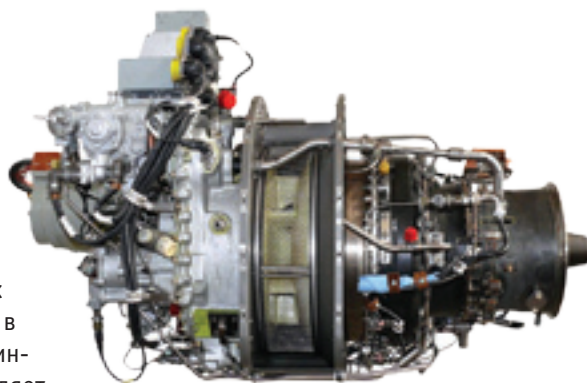
AI-450M - малоразмерный турбовальный двигатель для модернизации вертолета Ми-2М
