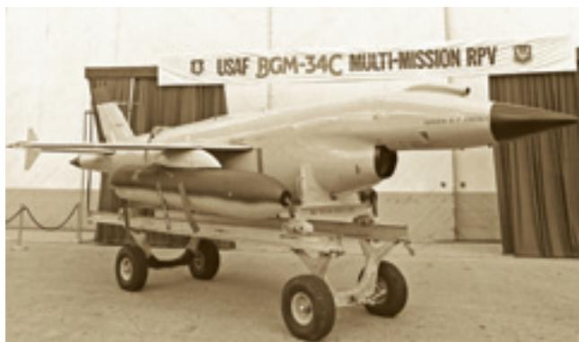
**В состав управляющего комплекса БЛА BGM-34C была впервые включена цифровая ЭВМ**
