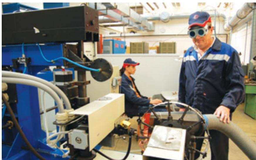
**Выполнение отверстий в секции жаровой трубы ОКС на пяти координатной лазерной установке**
