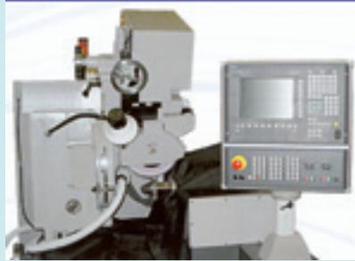
**Модель МШ350С - зубошлифовальный инструментальный станок с ЧПУ**
