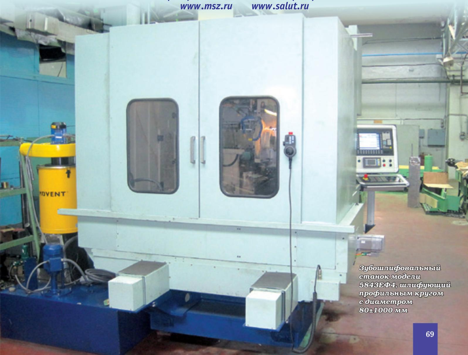
**Зубошлифовальный станок модели 5843ЕФ4, шлифующий профильным кругом с диаметром 80±1000 мм**
