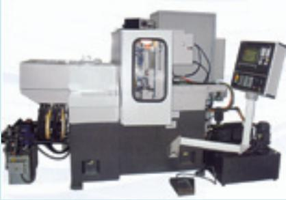
**Модель МШ204 - внутришлифовальный полуавтомат с ЧПУ для шлифования отверстий и торцов в деталях типа тел вращения**
