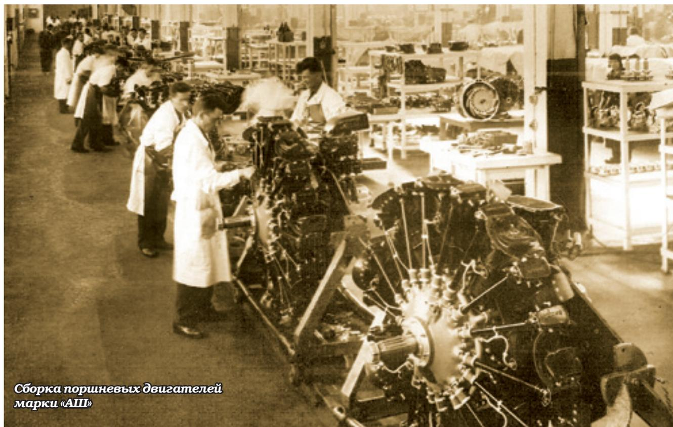
**Сборка поршневых двигателей марки «АШ»**
