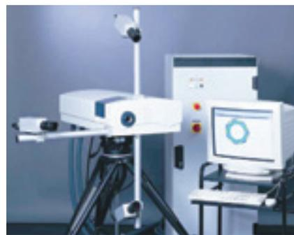
**Dantec Dynamics, Оптическая система для исследования форм колебаний**
