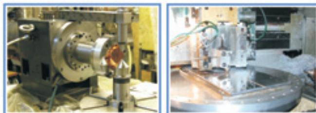
**Обработка матрицы линзы Френеля для изготовления концентраторов солнечного света в гелиевой энергетике
