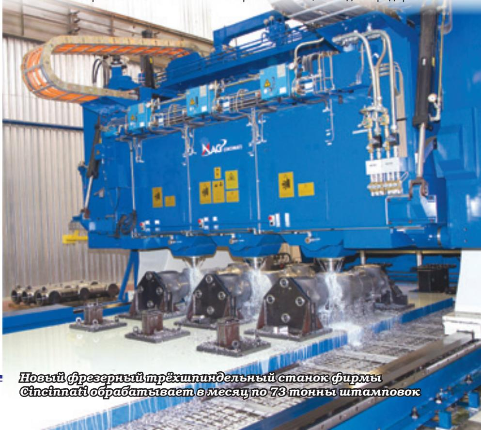
**Новый фрезерный трёхшпиндельный станок фирмы Cincinnati обрабатывает в месяц по 73 тонны штамповок**
