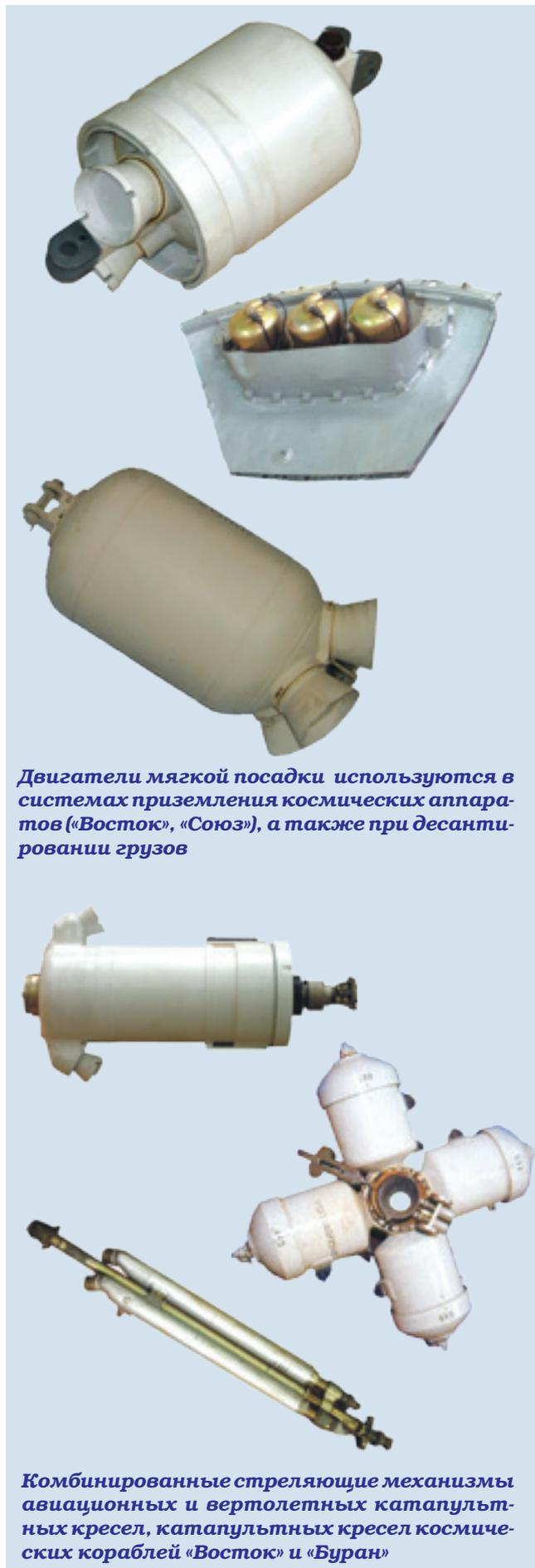
*Двигатели мягкой посадки используются в системах приземления космических аппаратов («Восток», «Союз»), а также при десантировании грузов*
