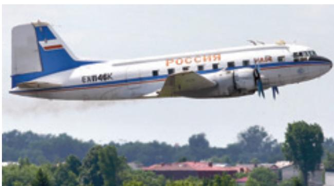
**Высокие экономичность и эффективность силовой установки Ил-14 были обеспечены за счет оснащения самолета мощными и надежными двигателями АИ-82Т**
