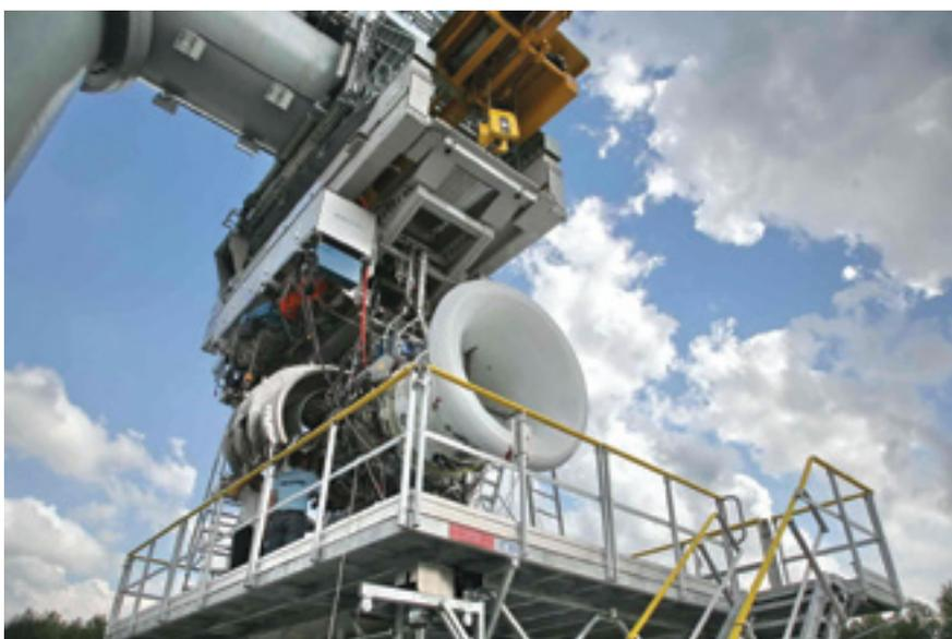
**Открытый испытательный стенд в Полуеве. Современная испытательная база НПО «Сатурн» соответствует всем требованиям международной сертификации авиационных двигателей**
