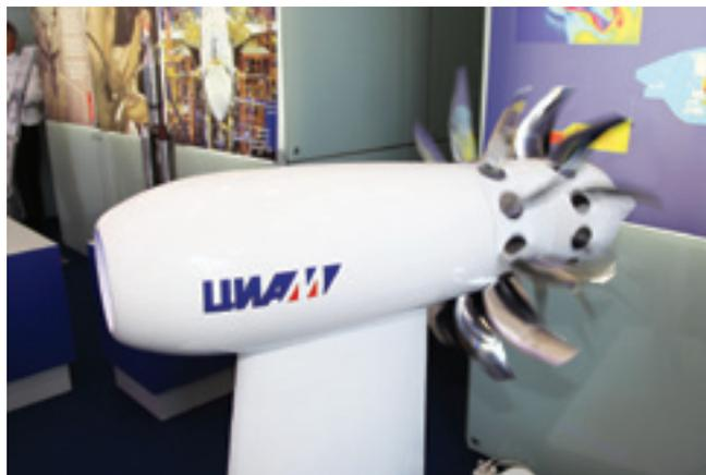
**Модель ТВВД с толкающим биротативным винтовентилятором**
