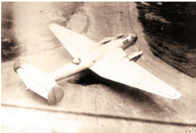
**Бомбардировщик ДБ-240 на испытаниях. Верхняя установка с пулеметом БТ в убранном положении**
