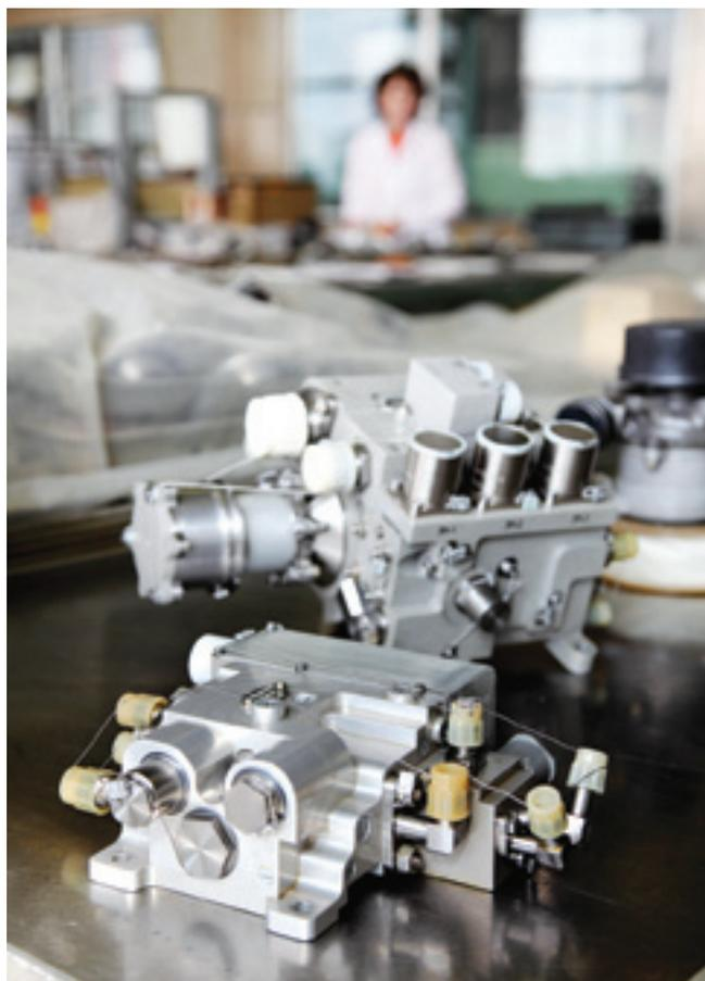
**Современные агрегаты топливо-регулирующей аппаратуры ГТД**
