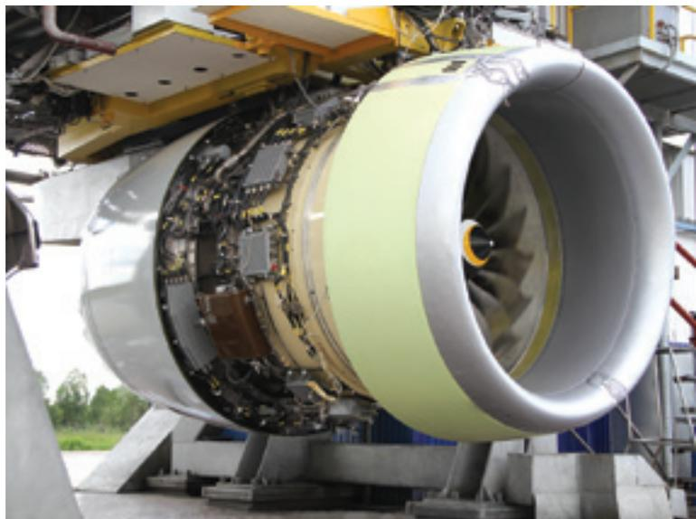
*Двигатель ПД-14 на открытом испытательном стенде ОАО «Авиадвигатель»*
