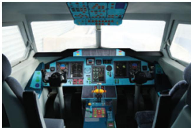
Ил-112В способен решать возлагаемые на него задачи в различных географических и климатических условиях, днем и ночью, в простых и сложных метеоусловиях. Самолет оборудуется современным цифровым комплексом бортового радиоэлектронного оборудования, «стеклянной кабиной». Обеспечивается возможность автоматического захода на посадку на категорированные аэродромы по минимуму II категории ИКАО и ручной заход на посадку на слабо оборудованные в радиотехническом отношении аэродромы.
