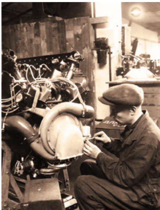
**Сборка мотора М-105**
