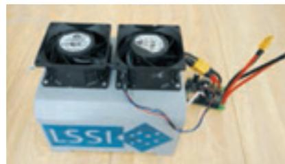
**Фото 2. Батарея твердполимерных топливных элементов с платой контроллера БЭУ**
