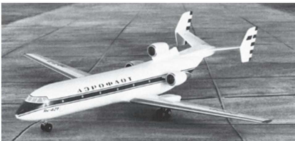
*Модель транспортного самолёта Як-42Т (видны гондолы шасси на задней кромке крыла)*
