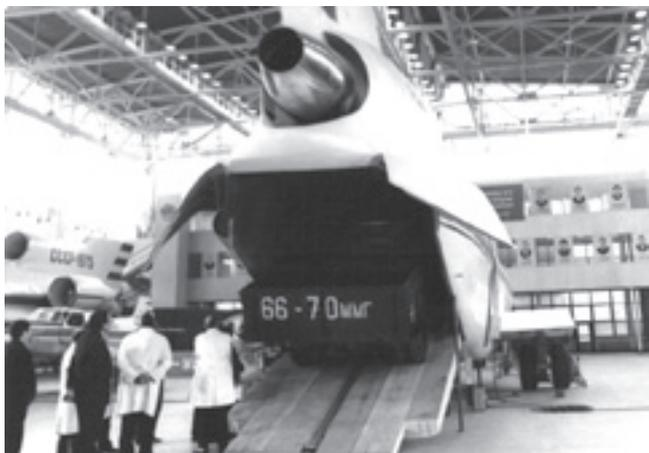
*Полноразмерный макет фюзеляжа Як-42 в грузовом варианте с хвостовой рампой*
