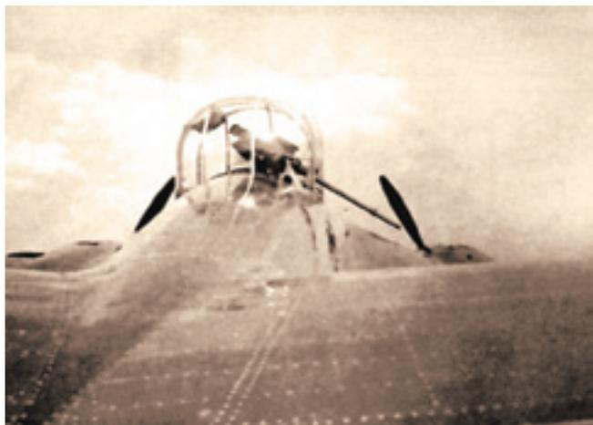
**Турель ТАТ-БТ в положении, обеспечивающем максимально возможный угол снижения оружия**
