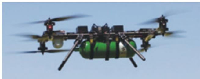
**Фото 1. Экспериментальный ДПЛА «НЕЛК-В8» в полете**
