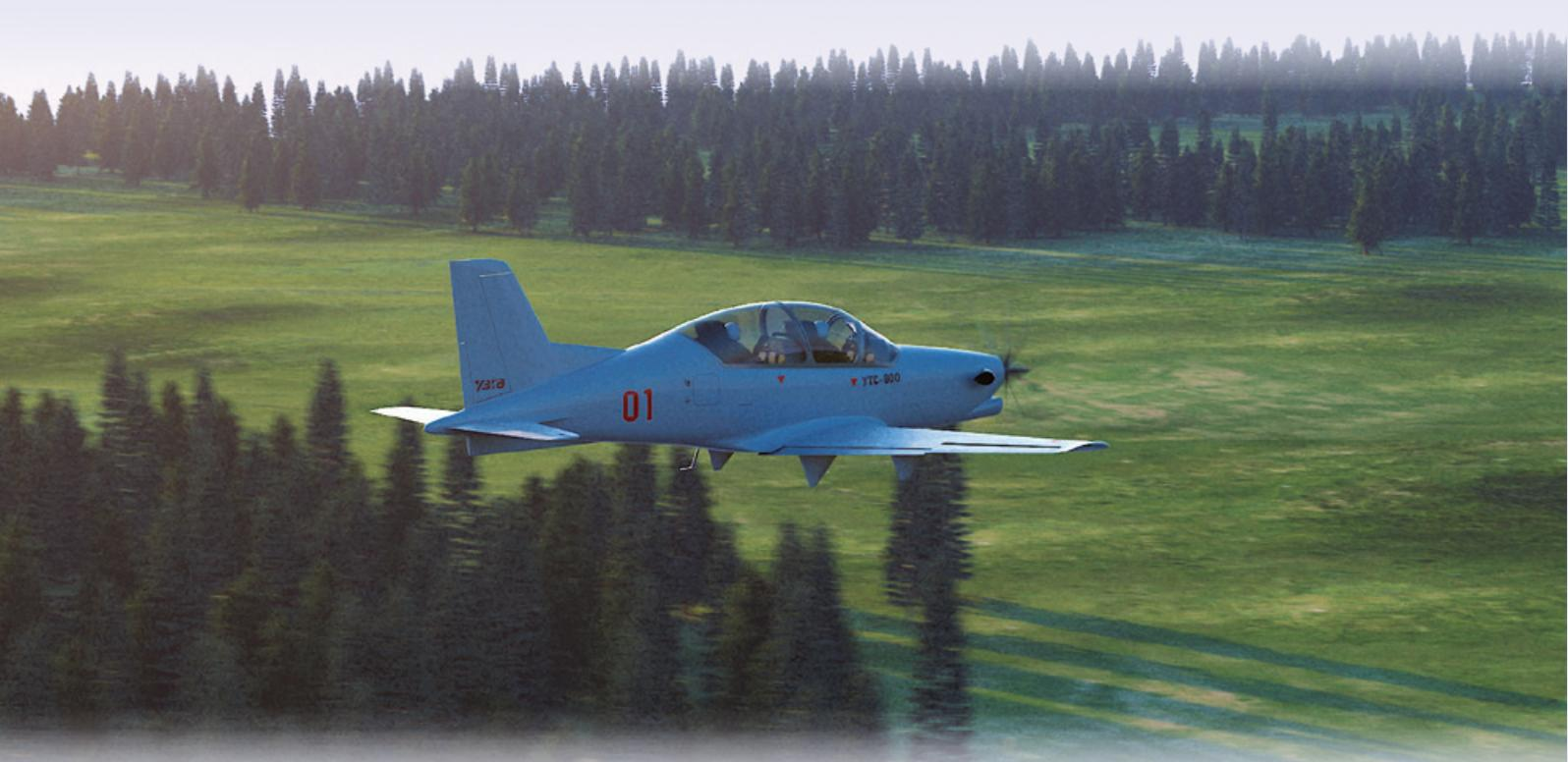
Силовая установка самолета состоит из одного турбовинтового двигателя ВК800СП и четырехлопастного винта АВ-410П. Мощность на валу на взлетном режиме 806 л.с.
