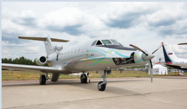
на базе двухсекционного турбированного роторно-поршневого авиадвигателя с мотором-генератором – ЭУ-РПД350Т.
