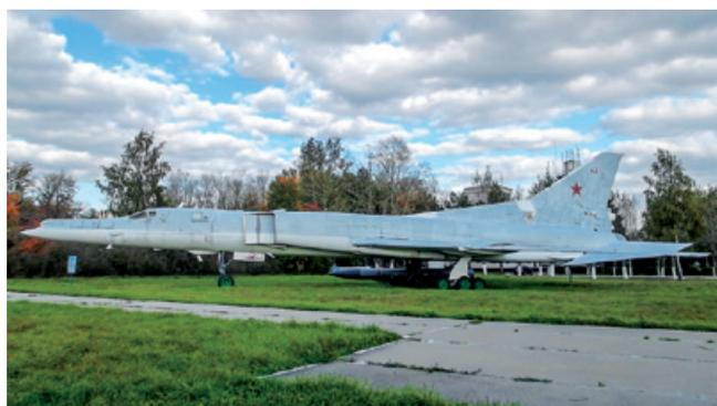
Это третья модификация многорежимного дальнего бомбардировщика-ракетоносца Ту-22М с крылом изменяемой в полёте стреловидности. Отличался новыми двигателями НК-22 и усовершенствованным бортовым оборудованием. Это был первый принятый на вооружение самолёт семейства Ту-22М. В апреле 1974 г. первые четыре Ту-22М2 поступили в Рязань, в этом же году Ту-22М2 начали получать строевые полки. Первым новую технику получил 185-й гвардейский
