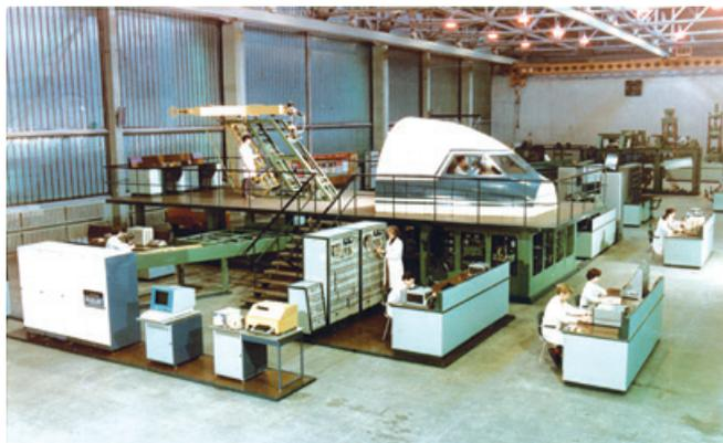
«Железная птица» – стенд, созданный в научно-исследовательском комплексе ОКБ А.С. Яковлева для наземной отработки систем новой машины, сократил в четыре раза количество испытательных полетов Як-42
