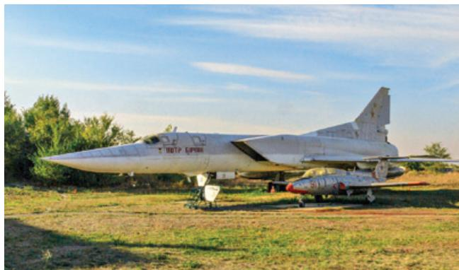
У самолёта широкий спектр вооружения: бомбы общим весом до 24 тонн, управляемые крылатые ракеты типа Х-22 и аэробаллистические гиперзвуковые ракеты. Высокие лётные характеристики достигнуты с помощью двух самых мощных в мире двухконтурных двигателей НК-25 с форсажной камерой.
