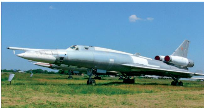
Ракетоносец **Ту-22КД** вооружался противокорабельной крылатой ракетой Х-22, а в хвостовой части фюзеляжа имелась пушка револьверного типа Р-23 конструкции Рихтера. Музейный самолёт базировался в Барановичах. Изготовлен в 1968 г., в музее с 2000 г.
