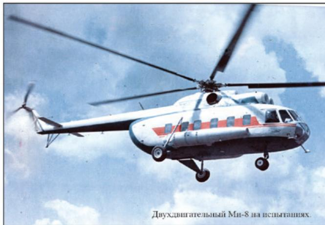
Двухдвигательный Ми-8 на испытаниях.
