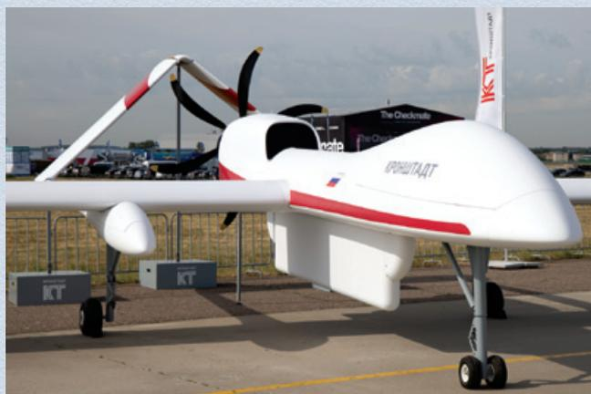
с гибридной силовой установкой. Летательный аппарат предназначен для проведения авиамониторинга на протяженных маршрутах, что делает его незаменимым для использования в нефтегазовой сфере.
