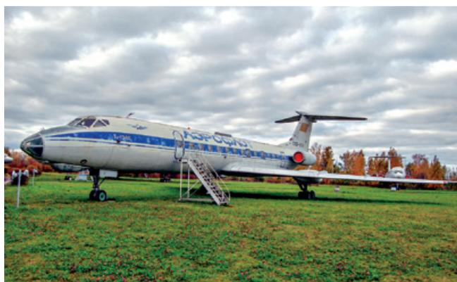
Модификация АК – это самолет с салоном 1 класса на 24 места и салоном «люкс» на 13 пассажиров. Построен в 1972 г. От обычного Ту-134 отличается наличием второй двери для пассажиров со встроенным трапом. Использовался в 232-м Отдельном правительственном авиаотряде (1972–1975 гг.), затем в Ульяновской школе высшей летной подготовки. Списан после исчерпания ресурса, в 1985 г. передан в музей. Интерьер салона не сохранился.
