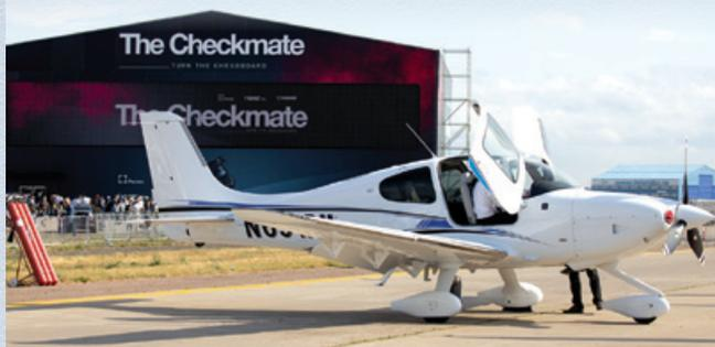
Одновигательный Cirrus SR22T, оснащённый поршневым двигателем с турбонаддувом, создан с широким применением композиционных материалов. Vision Jet – также одновигательный самолёт, который поднимает в воздух реактивный двигатель. Он может принять на борт до 7 человек. Оба самолёта от Cirrus оснащены парашютной системой спасения, позволяющей выполнить безопасную посадку в случае отказа силовой установки или в других ситуациях.
