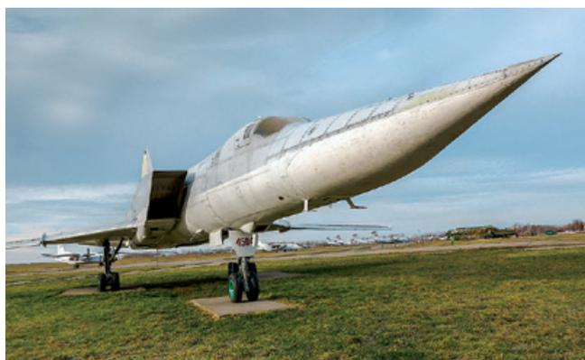
Это последняя модификация самолётов Ту-22М. Её разработка началась в 1983 г. на базе Ту-22М3. Доработки заключались в установке новых двигателей НК-32 от самолёта Ту-160 и изменении воздухозаборников двигателей, установке нового радиоэлектронного оборудования и комплекса РЭБ. Была расширена номенклатура средств поражения: 6 управляемых ракет Х-32 или 10 управляемых ракет Х-57 с размещением на 6 внутренних и 4 внешних точках подвески или бомбы УПАБ-1500 с телевизионной
