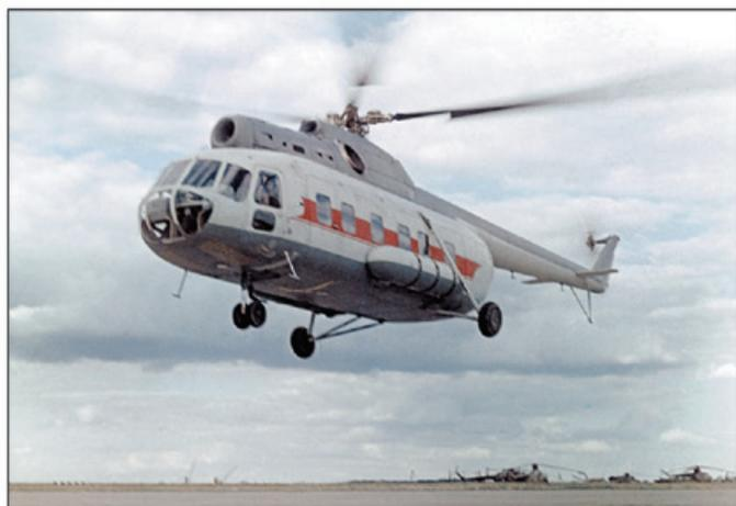
В-8 - первый однодвигательный прототип.
