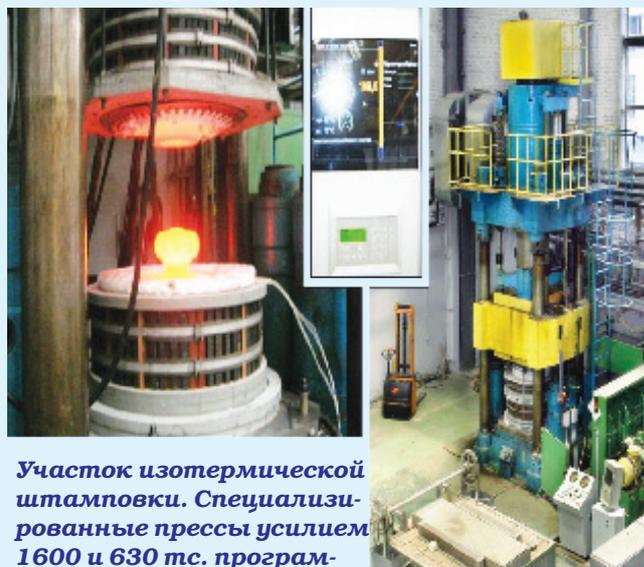
**Участок изотермической штамповки. Специализированные прессы усилием 1600 и 630 тс. Программное управление процессами нагрева заготовок и штамповки**
