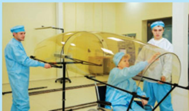
**Откидная часть фонаря кабины летчика с нанопокрывтием**
