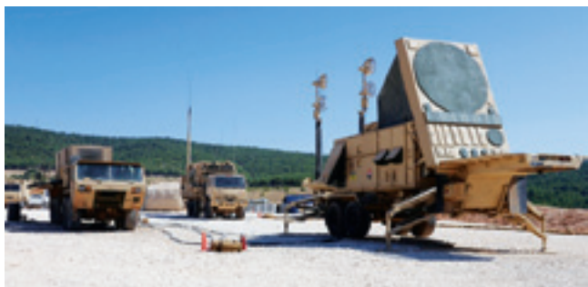
Справа – РЛС AN/MPQ-53. За ней видны две антенны радиорелейной станции ОЕ-349, в центре (на заднем плане) – станция управления перехватом AN/MSQ-104, с убранными антеннами. Слева – силовая установка ЕРР, которая снабжает электроэнергией все машины комплекса
