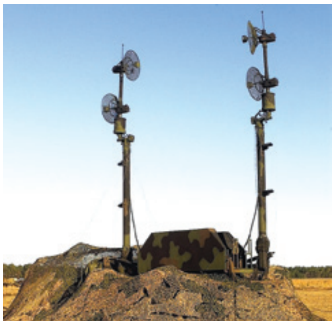
Радиорелейная станция ОЕ-349 принимает внешнее целеуказание и передаёт собственные данные на верхний уровень управления
