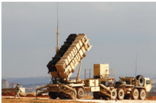
Пусковая установка М901 с четырьмя контейнерами для ракет МІМ-104А или МІМ-104В
