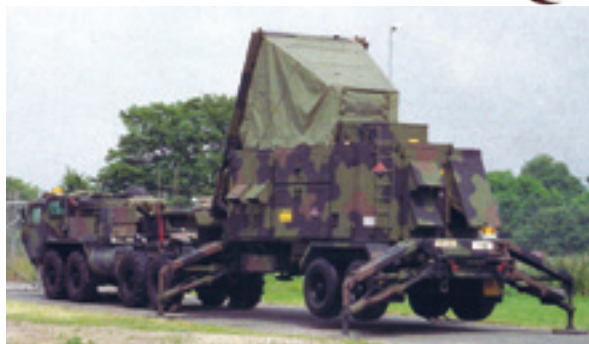
Радиолокационная станция AN/MPQ-53 – сердце комплекса Пэтриот
