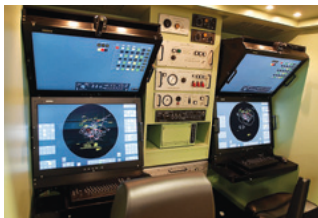
Последняя версия пультов операторов ЗРК Пэтриот получила два дополнительных ЖК экрана над мониторами отображения обстановки
