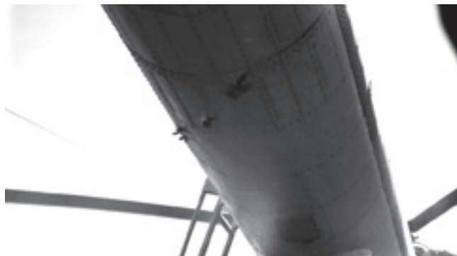
Боевая живучесть вертолета Ми-8 МТВ: после боевого вылета с пробоинами в хвостовой балке. Афганистан. Гульхана. 1985 г.
