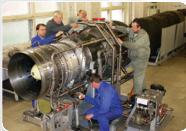
Работы по обвязке АЛ-55. В.Г. Дубинин - второй слева
