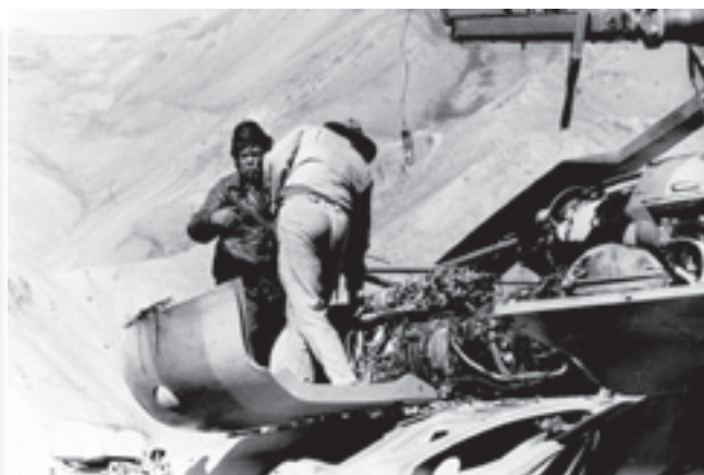
Замена двигателя вертолета Ми-8 МТ в полевых условиях. Слева – зам. командира 2-й авиаэскадрильи по ИАС Алма-атинского авиаполка майор Панин В.И. Афганистан. Гульхана. 1986г.
