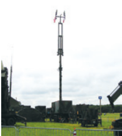
Станция управления перехватом AN/MSQ-104. Принимает информацию с ракеты и передаёт на её борт команды управления
