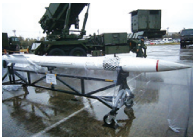
Ракета MIM-104F (РАС-3) комплекса Пэтриот оптимизирована для поражения баллистических целей. Ракета закрыта от дождя целлофаном, но сопла микродвигателей системы управления рассмотреть можно. Ракета дорогая – более 3 млн. долларов за штуку
