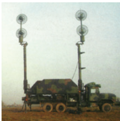
Радиорелейная станция ОЕ-349. В зависимости от страны, где Пэтриот состоит на вооружении, его оборудование монтируется на разных типах автомобильных шасси
