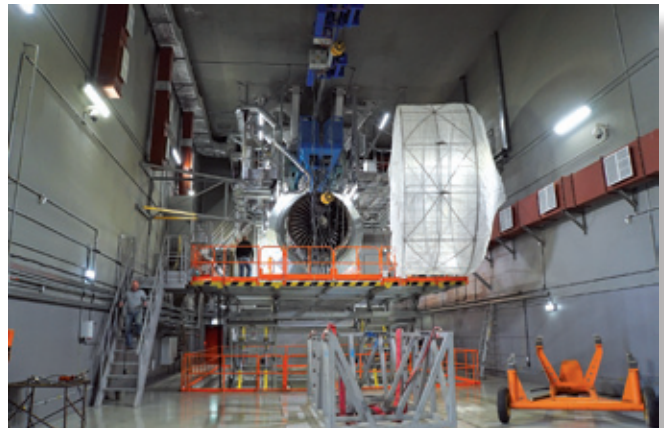
Стенд для испытания двигателя Д-18Т в наземных условиях на АО «УЗГА»
