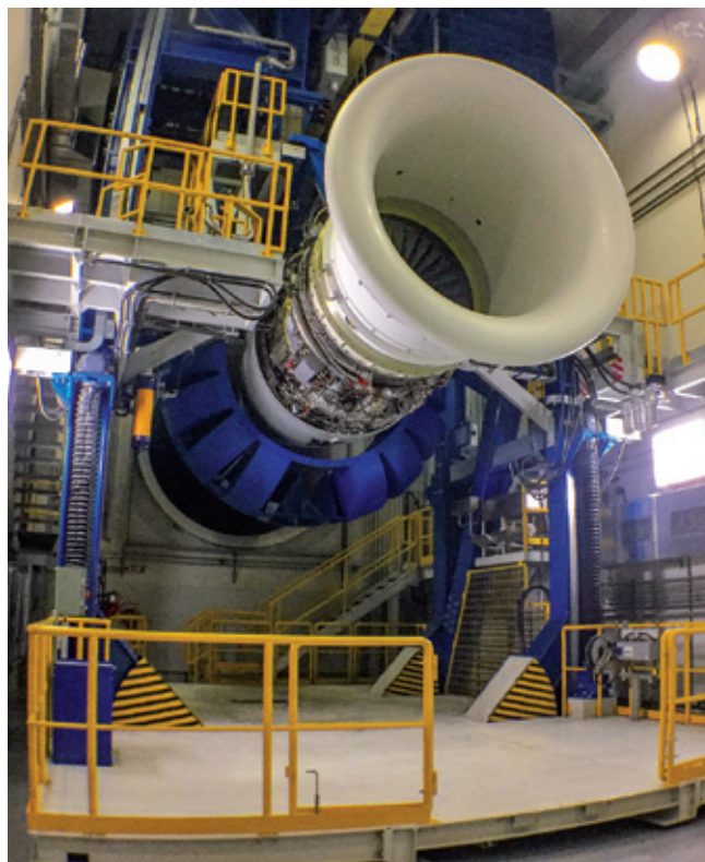
Испытательный стенд для авиационных двигателей ПС-90А и ПД-14 с адаптерной системой на загородной испытательной станции в Пермском крае в Новых Лядах
