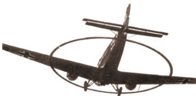
Немецкий самолёт-тральщик Ju-52MS, наиболее эффективное средство борьбы с неконтактными донными минами
