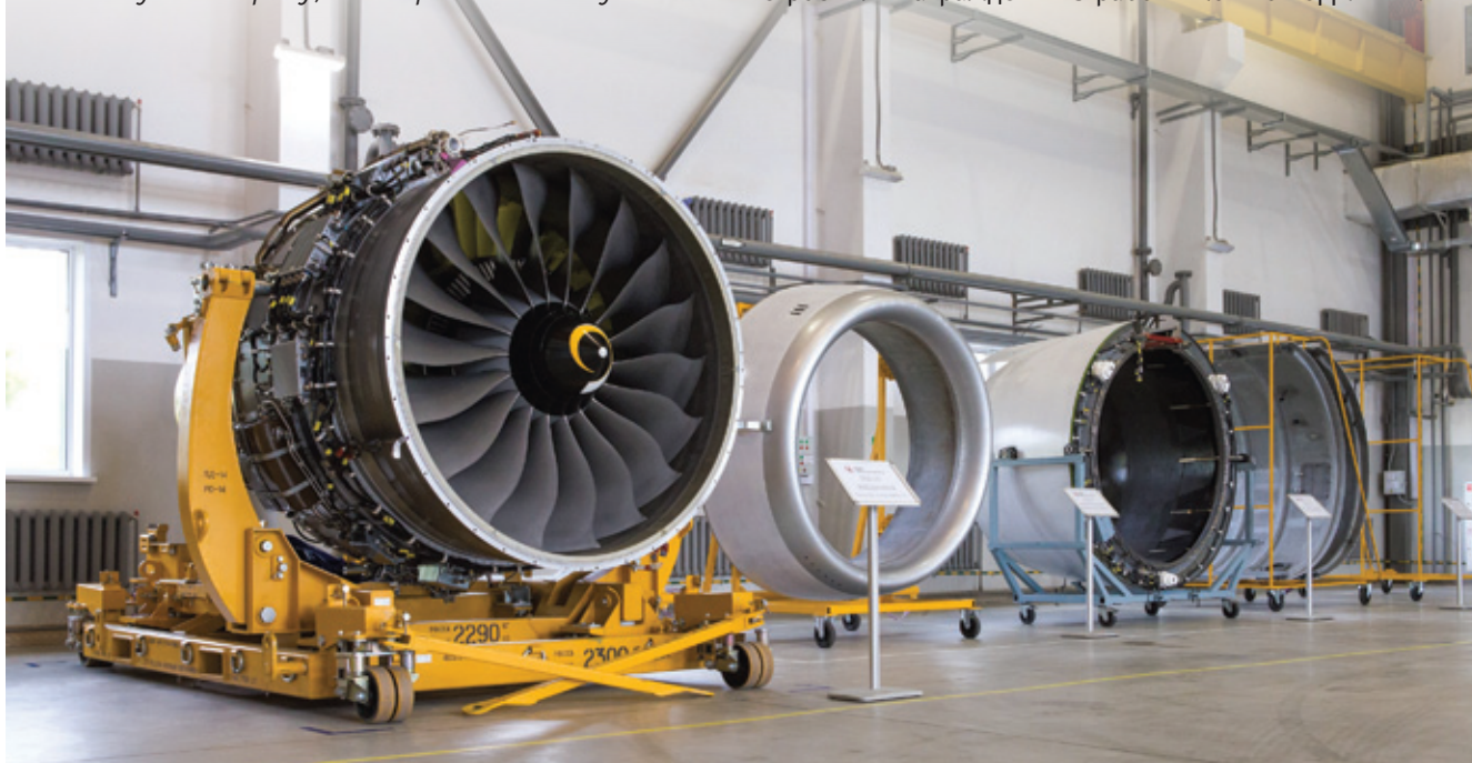
ПД-14 в зале подготовки загородной испытательной станции «ОДК-Пермские моторы»
