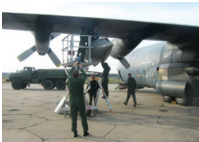
Послеполётное обслуживание контейнера SAMSON с аппаратурой наблюдения на французском С-130Н-30
