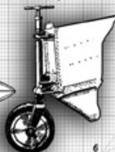
Хвостовое колесо перекаточного шасси закрепленное на законцовке поплавка
