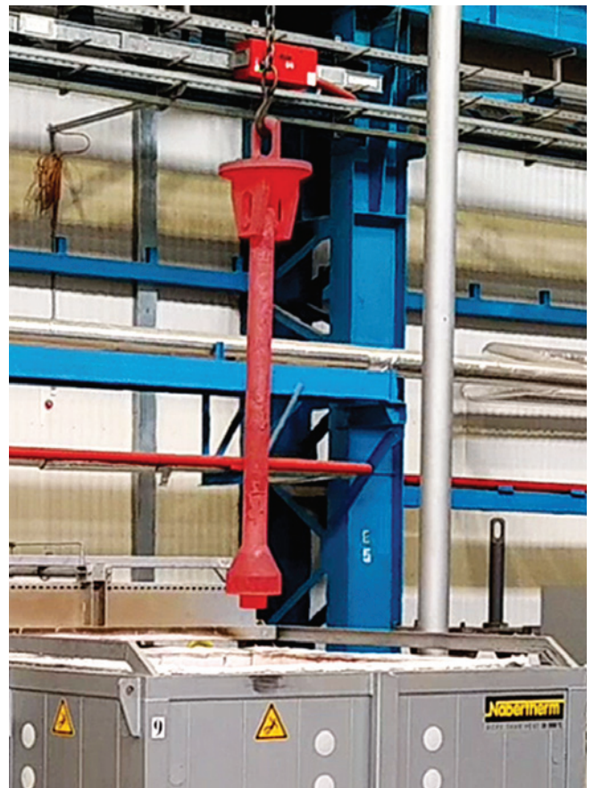
Процесс закалки вала из стали ВКС180-ИД
