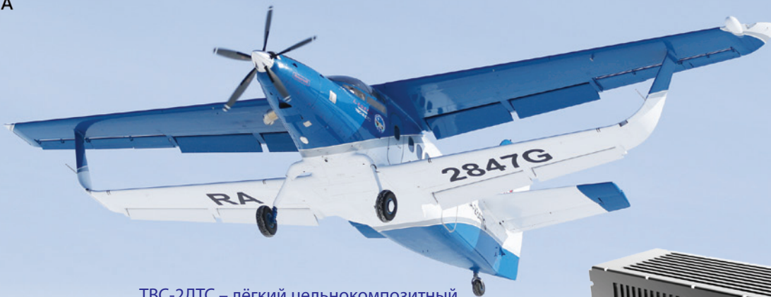
ТВС-2ДТС – лёгкий цельнокомпозитный многоцелевой самолёт
