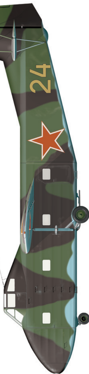
228 Тяжелый грузовой планер Як-14 "24 желтый", 334-й тпдп, 1954 г. Десантный планер Як-14 конструкции А.С. Яковлева был разработан в 1948 году. Буксировался самолетом Ил-12. Предназначался для переброски живой силы (до 25 человек десанта) и боевой техники общим весом 3,4 т. В ВГА состоял на вооружении до 1959 года.
