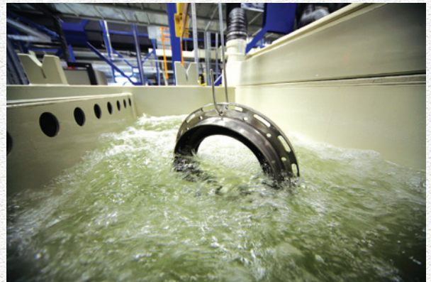
Процесс промывки детали после нанесения гальванического покрытия
