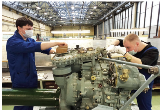
Сборка редуктора ВР-382
