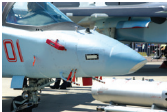
Як-130 с лазерным целеуказателем
