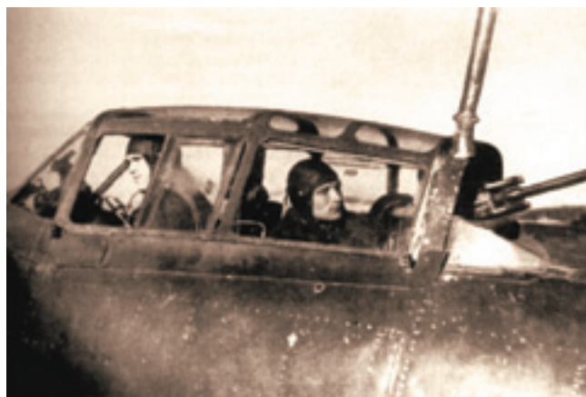
Верхняя установка «ФТ» с пулеметом БТ, разработанная инициативной группой конструкторов во главе с Л.Л. Селяковым на казанском авиазаводе, именовалась «ремонтной», однако около пятисот «пешек» получили ее на этапе изготовления
