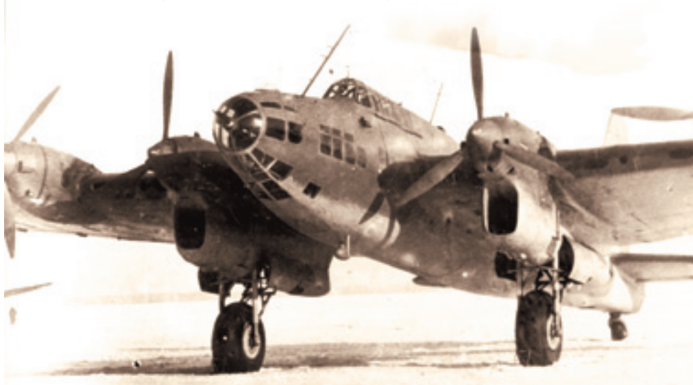
С 1943 г. на Пе-8 взамен не оправдавших себя башен НЭБ-42 с пулеметами ШКАС была введена типовая для самолетов Aviации дальнего действия носовая установка с пулеметом УБТ в шаровом подвесе. На фото – самолет с дизелями АЧ-30Б
