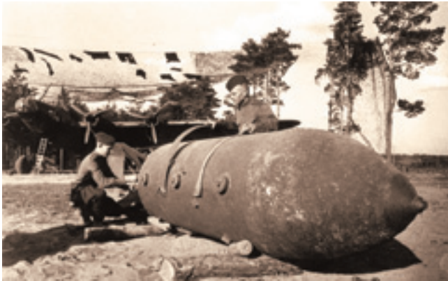
Самолет Пе-8 (с моторами АШ-82Ф или АЧ-30Б) был единственным в советских ВВС носителем бомбы ФАБ-5000ТГА. Для надежности срабатывания бомба снабжалась восемью взрывателями: головным, донным и шестью боковыми
