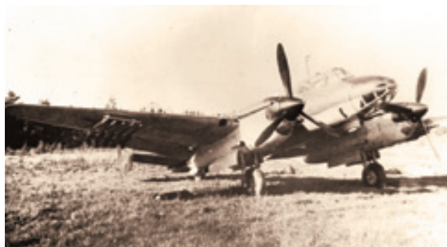
В сентябре 1941 г. на ногинском полигоне ВВС прошел испытания Пе-2, вооруженный десятью реактивными орудиями РО-132
