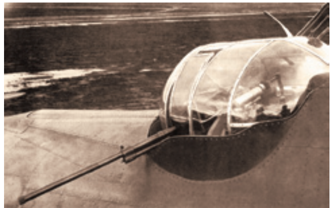
Верхняя тяжелая аэродинамическая турель ТАТ с пушкой ШВАК. В одном из боевых полетов воздушный стрелок ТБ-7 сбил два истребителя противника (по докладу, члены экипажа наблюдали падение горящих истребителей вплоть до удара о землю)
