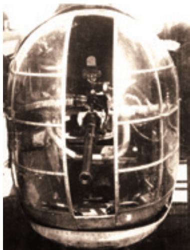
Кормовой турелью с пушкой ШВАК были переоснащены почти все выпущенные ранее ТБ-7 (включая несерийную машину 385 «Д» - второй опытный АНТ-42) и более поздние Пе-8
