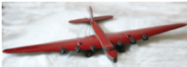
Модель самолета АНТ-20 бис (ПС-124, бортовой номер Л-760). Изготовлена в макетном цехе ОКБ А.Н. Туполева в марте 1937 года. Фото П.Б. Смирнова, сделанное в августе 2015 года. На АНТ-20 бис, как и на «МГ», были кабинки механиков. Масштаб 1:50.
