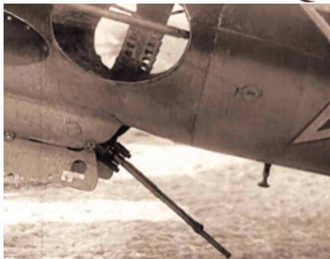
Люковая установка с пулеметом УБТ калибра 12,7 мм заметно увеличила обороноспособность бомбардировщика
