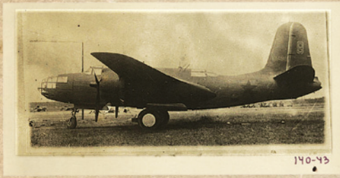
Самолет "Дуглас А-20-В", вооруженный самолетным радиолокатором "Гнейс-2".
