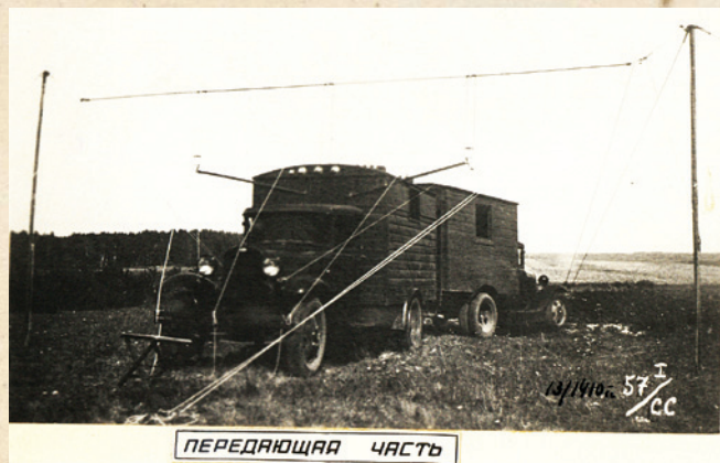
РЛС «РУС-1» – передающая и приёмная части
