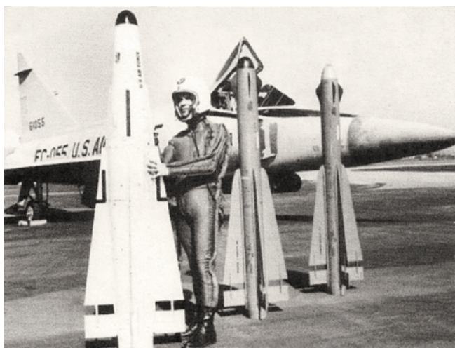
Длинная рука системы Хьюз ECF/FCS – ракеты «воздух – воздух» от того же производителя. Лётчик-испытатель фирмы Хьюз Крис Смит держит ракету «Биг Бумер» AIM-26A (оригинальное обозначение GAR-11A) Супер Фалкон с ядерной БЧ. За ним стоят стандартные ракеты AIM-4A (GAR-1D) Фалкон с полуактивным радиолокационным самонаведением и AIM-4C (GAR-2A) Фалкон с пассивным инфракрасным самонаведением
