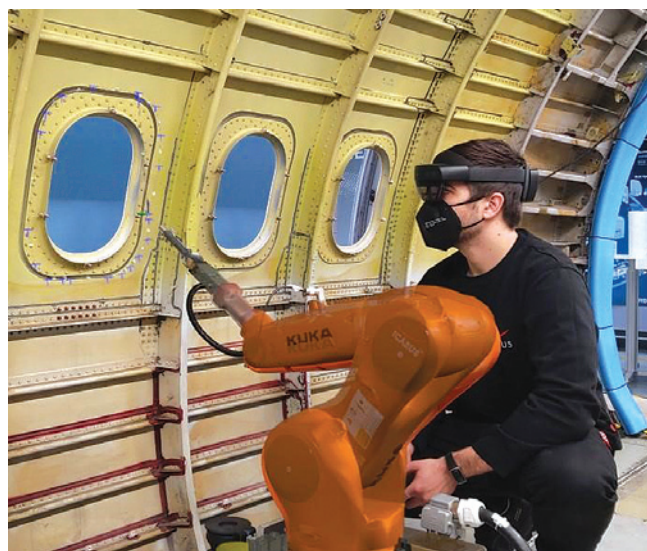
Программирование роботов-манипуляторов с помощью дополненной реальности при производстве самолётов
