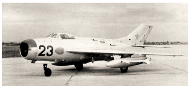
МиГ-19ПТ (СМ-7/2Т) №23, т.е. МиГ-19П, адаптированный в 1960-х годах для размещения на внешних пилонх под крыльями управляемых ракет Р-3С (К-13А) с инфракрасным самонаведением
