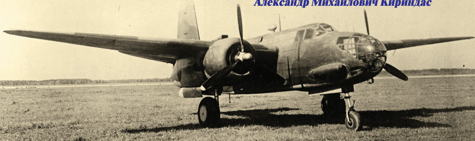
Самолёт «Бостон-3» с бортовой РЛС «Гнейс-2»
