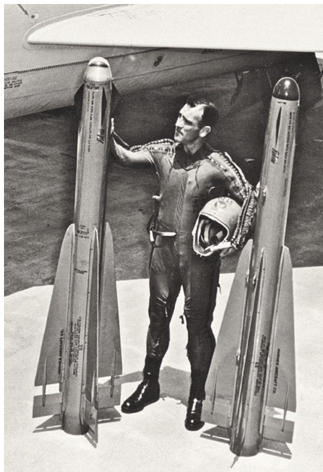
Слева – ракета GAR-2 (AIM-4B) с ИК головкой самонаведения. Справа - GAR-1D (AIM-4A) с ПА РЛС самонаведением. Ракеты имеют практически одинаковый планер. Рули отнесены от задней кромки крыла. На заднем плане – перехватчик F-102A
