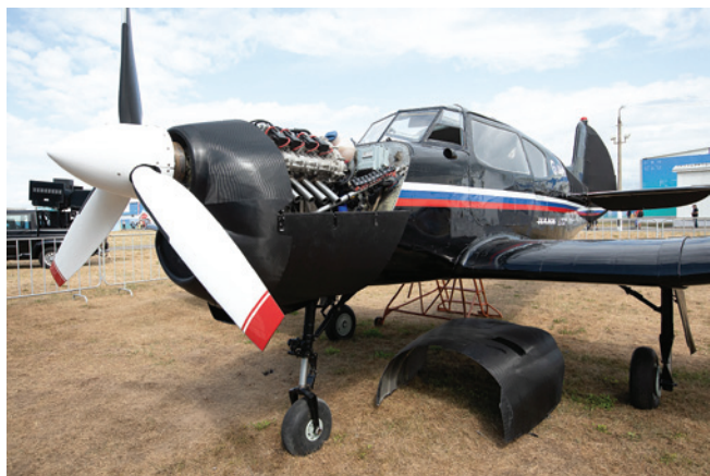
Поршневой двигатель АПД-500 мощностью 500 л.с., установленный на летательный аппарат Як-18Т
