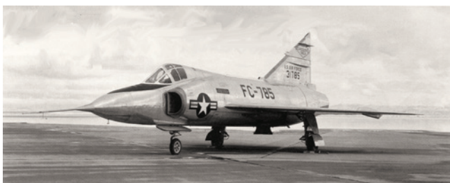
Предпоследний опытный YF-102 (53-1785) во время испытаний в Летно-исследовательском центре НАСА в 1955 году. Самолёты YF-102 не могли превысить скорость звука в горизонтальном полёте из-за слишком высокого волнового сопротивления
