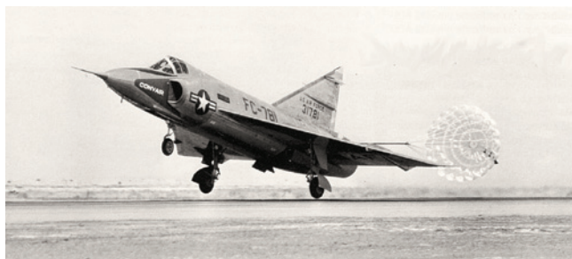
YF-102 (53-1781) при посадке с раскрытым тормозным парашютом. Видно, что парашют был выпущен до того, как колёса коснулись земли
