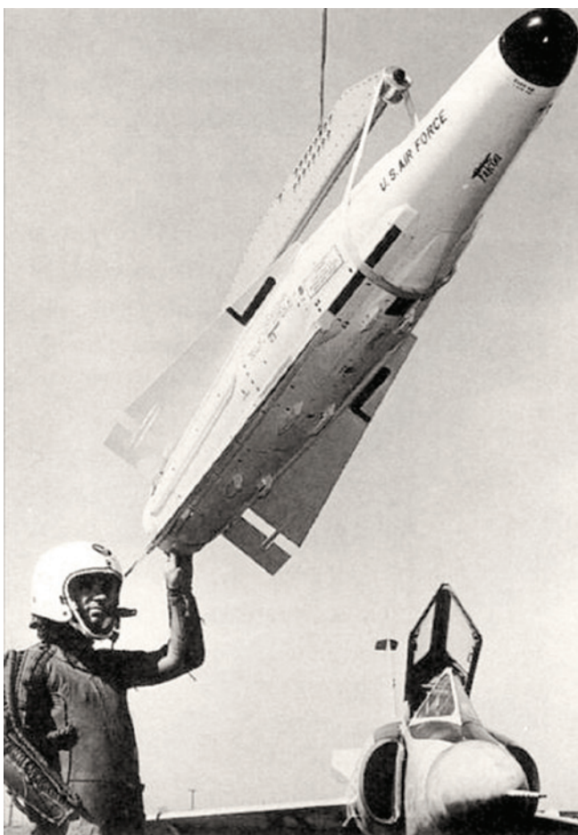
Управляемая ракета AIM-26 Супер Фалкон с ядерной боевой частью мощностью 1,5 кТ. Имеет полуактивное радиолокационное самонаведение
