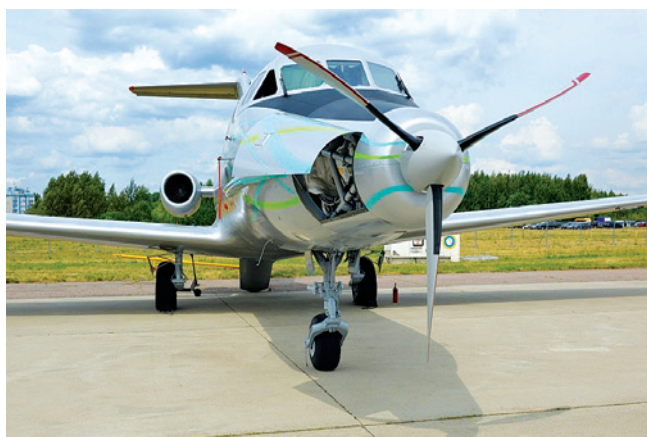
Летающая лаборатория Як-40ЛЛ с гибридной силовой установкой
