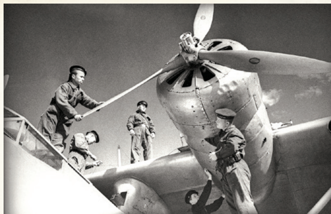
Подготовка к боевому вылету летающей лодки ГСТ 118-го орап ВВС СФ. На самолете установлены двигатели М-62ИР, но импортные воздушные винты, поскольку на лопастях нанесены характерные эмблемы производителя – фирмы Hamilton Standard
