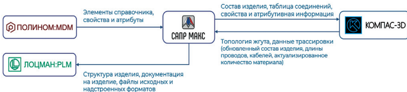
Схема информационного обмена между системами САПР «Макс», ПОЛИНОМ:MDM, ЛОЦМАН:PLM, КОМПАС-3D реализованная в рамках проекта по импортозамещению на АО «ОДК-Авиадвигатель»
