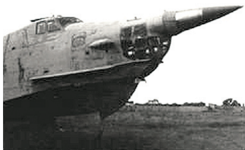
Носовая часть летающей лаборатории «Москит» (самолёт Бе-12, заводской № 060194)
