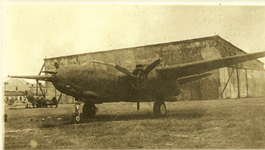
Самолет "Дуглас А-20-С" вооруженный самолетным радиолокатором "Гнейс-2".
