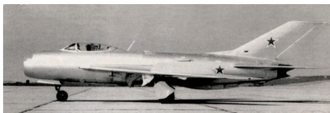
Первый прототип перехватчика СМ-7/1. По сравнению с дневным истребителем МиГ-19 (СМ-9) он имел удлинённую переднюю часть фюзеляжа с РЛС РП-1 «Изумруд». Его лётные испытания провёл лётчик-испытатель В.А. Нефёдов 28 августа 1954 г.
