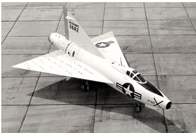
Демонстратор технологий. Самолёт с треугольным крылом XF-92A. На крыле и хвостовой части фюзеляжа наклеены ленточки для изучения обтекания в полёте.
