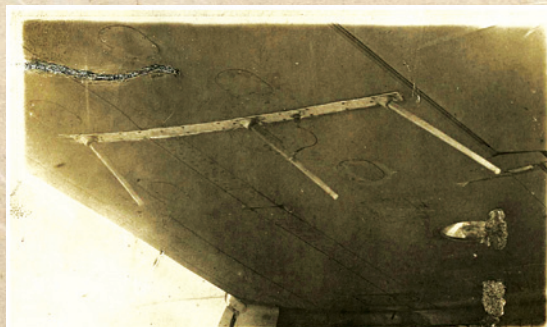
Нижняя зенитная антенна /" низ "/
