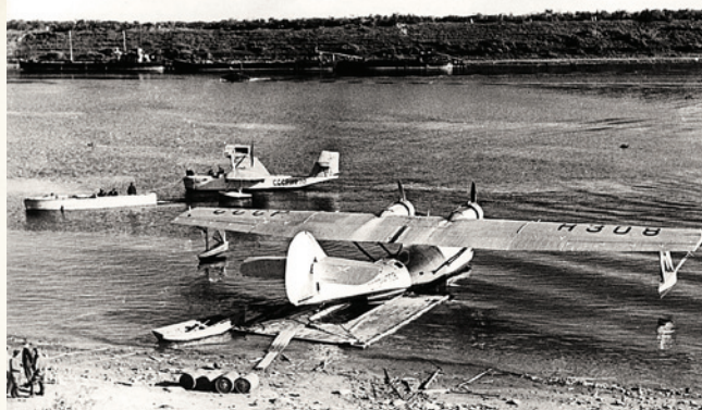
Гидросамолет МП-7 СССР-Н308 Полярной авиации. На заднем плане летающая лодка МП-1 (гражданский вариант МБР-2-М-17)
