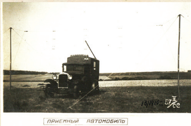
РЛС «РУС-1» – передающая и приёмная части
