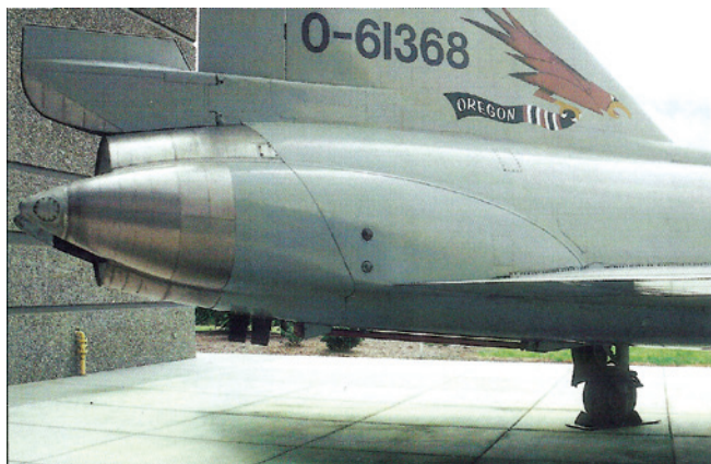
«Нашлёпки» на хвостовой части фюзеляжа сделаны для соблюдения правила площадей. Под фюзеляжем виден гак для аварийного торможения
