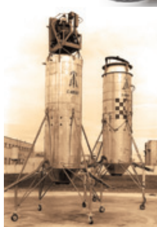
«Летающие Атары» фирмы SNECMA. На переднем плане пилотируемый С.400 Р.2.
