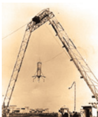
Стенд С.400 Р.1 совершает привязной полет подвешенный под 35-метровый козловый кран
