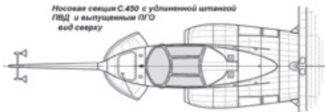
Носовая секция С.450 с удлиненной штангой ПВД и убраным ПГО вид сверху
