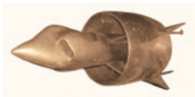
Продувочная модель С.450 с боковыми воздухозаборниками
