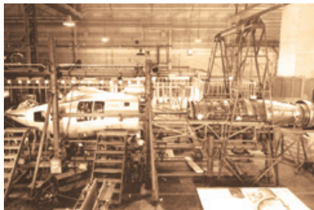
Сборка самолета С.450
