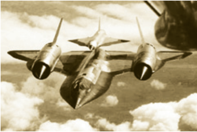
Самолет-носитель M-21 с установленным над фюзеляжем D-21
