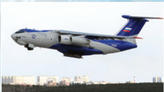
Летающая лаборатория Ил-76ЛЛ №0807 с двигателем ПД-14 в воздухе
