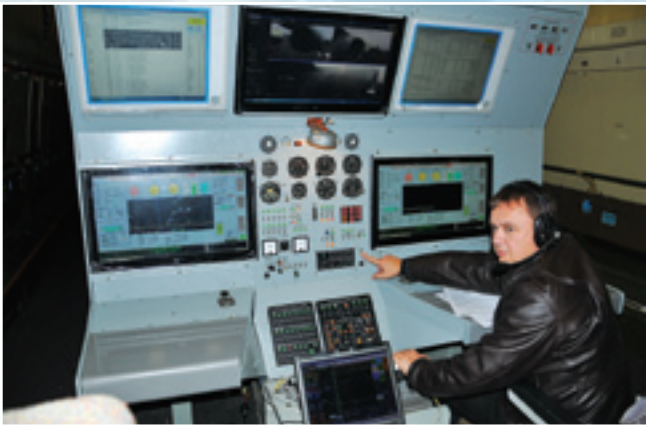
Инженер за пультом управления двигателем ПД-14 в грузовой кабине Ил-76ЛЛ №0807
