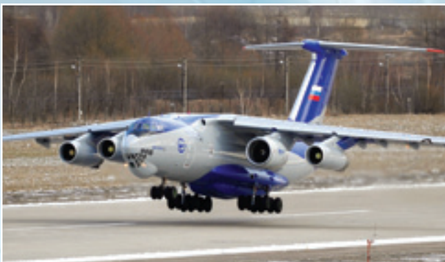
Ил-76ЛЛ №0807 с двигателем ПД-14 за мгновение до касания полосы
