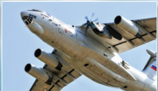
Летающая лаборатория Ил-76ЛЛ №3908 с двигателем ТВ7-117СТ и винтом АВ112 в полёте
