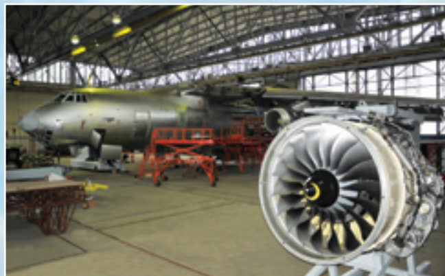
Двигатель ПД-14 перед монтажом на летающую лабораторию Ил-76ЛЛ №0807
