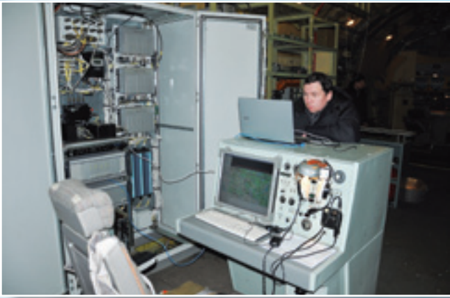
Оборудование рабочих мест инженеров в грузовой кабине Ил-76ЛЛ
