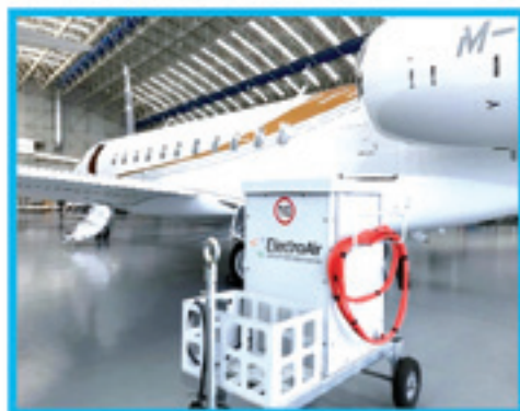
Аэродромные источники питания переменного напряжения 200В 400Гц и постоянного тока 27В
