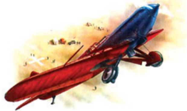
И-17 (ЦКБ-15) убирает шасси поворотом от оси самолёта
