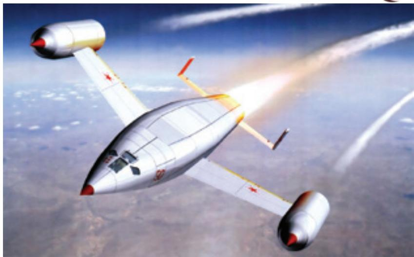
**Вариант «волнолета» НИИ-1, отличавшийся от аппарата Зенгера-Бредт применением СПВРД, смонтированных на концах крыла**
