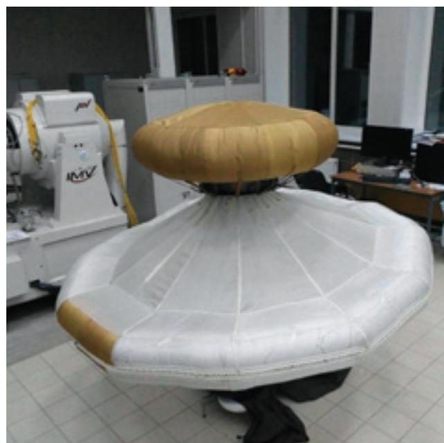
**Подготовка образца инновационного спускаемого аппарата к испытаниям**
