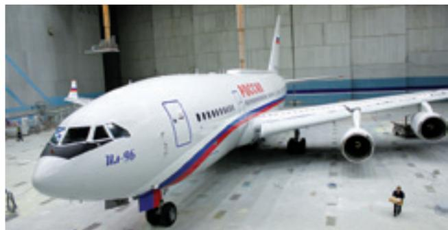
Использование современных полиуретановых эмалей с высоким содержанием сухого остатка и системы «база – лак» улучшает эксплуатационные, аэродинамические характеристики ВС, обеспечивает практическую экономию топлива от 3 до 7%, в сочетании со стойким к излучению «UVR» лаком, экономит 40-75% времени на внешней мойке ВС и увеличивает срок
