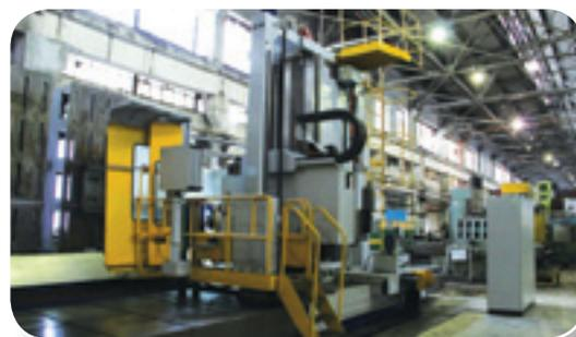
**Программный фрезерный станок LP212F3 для обработки пространственных сложных поверхностей изделий**
