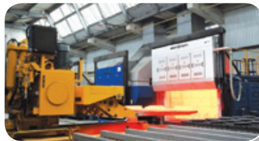
**Выгрузка заготовок из печи Electrotherm при помощи автоматизированной загрузочной машины GLAMA**
