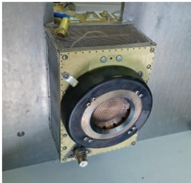
**Опытный образец высокочастотного импульсного двигателя ВЧИД-8**
