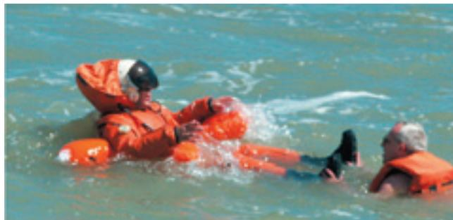
спасательный пояс АСП-6А с автоматической системой газонаполнения. Государственные испытания АСП-6А прошел с положительными результатами.
