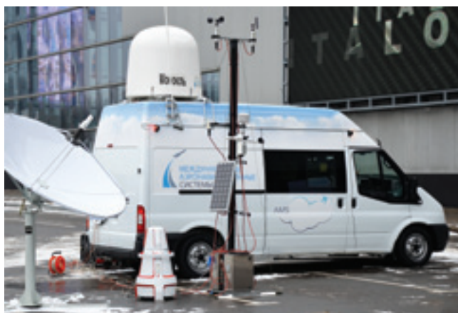
Мобильный интегрированный метеокомплекс «Сварог»
