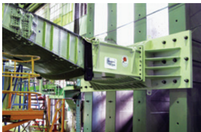
Имитатор центроплана самолета MC-21. ГНЦ ФГУП «ЦАГИ»
