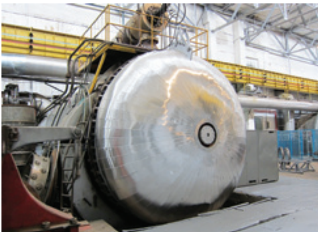
Стенд испытания авиационных двигателей 5-го поколения ПД-14. ФГУП «ЦИАМ им. П.И. Баранова»
