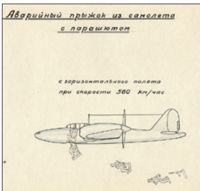
Схема покидания самолёта «104» через нижний люк
