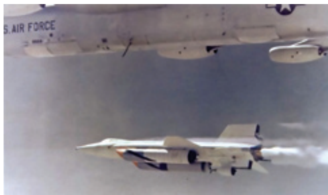
Отделение ракетоплана X-15А-2 с дополнительными баками от самолета-носителя B-52. Под нижним килем смонтирован сверхзвуковой прямоточный ВРД, оторвавшийся в полете
