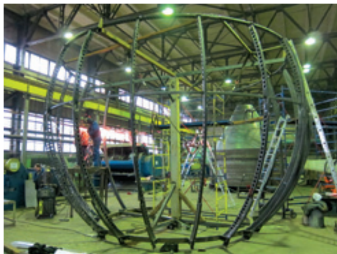
Каркас силовой проекционной системы. ОАО «Авиационные тренажеры»
