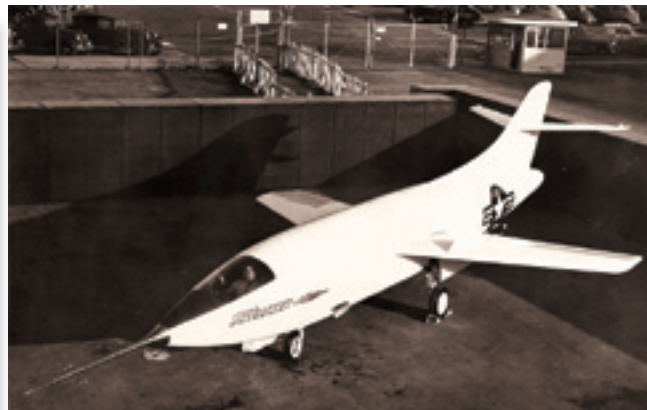
Экспериментальный ракетоплан Douglas D-558-II «Скайрокет» оказался первым летательным аппаратом, способным достигнуть числа M = 2
