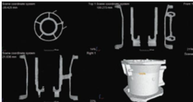
Рис. 5. Общая 3D-модель изделия с сечениями по трем осям координат (томографические срезы)
