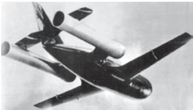
**Продувочная модель Me-328 с вариантом размещения двигателей на хвостовой части фюзеляжа. Выхлопные трубы крепятся к стабилизатору. На крыльях видны кронштейны для установки модели в аэродинамической трубе**
