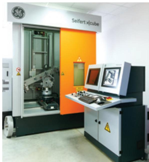
Рис. 4. 2D-исследование крышки картера в рентгеновской установке X-Cube XL 225 на наличие внутренних трещин и пустот
