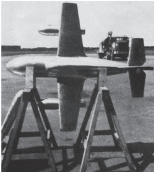
*Продувочная модель Me-328 с одним из вариантов размещения двигателей под крылом*
