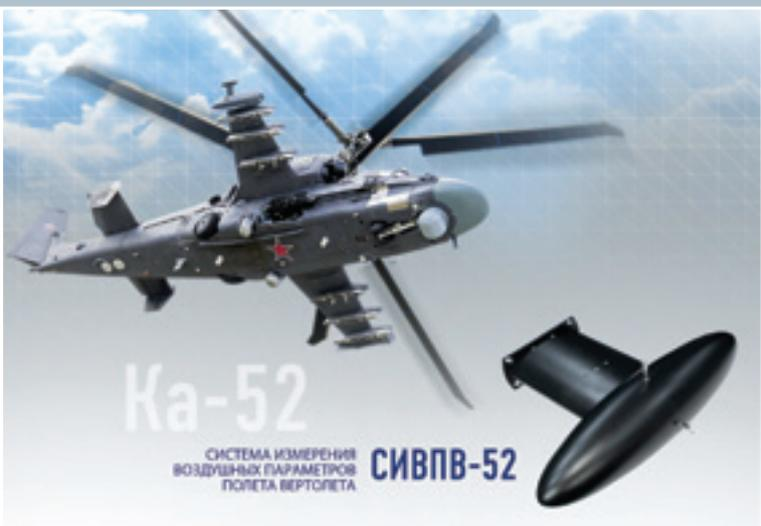
В состав системы входят: вычислитель высотно-скоростных параметров ВВСП-БЛА; плата статического давления ПДС-БЛА; приемник полного давления ППД-БЛА; приемник температуры П-120.
