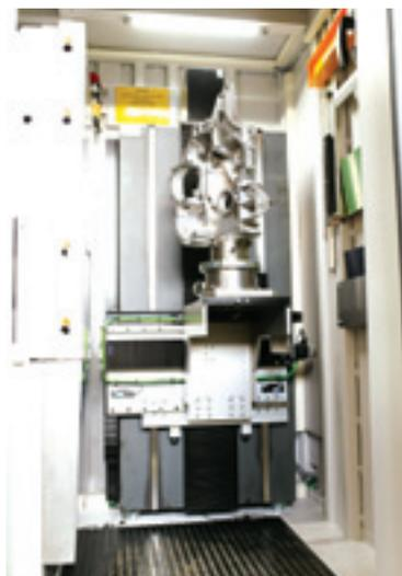
Рис. 2. Крышка картера, установленная в томограф vltomelx s450 для исследований внутренних пустот
