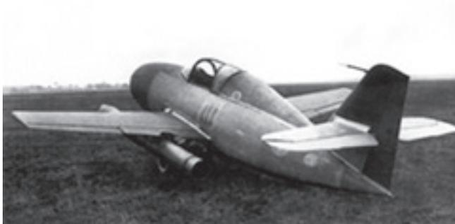
**Прототип бомбардировщика Me 328B-0. Вид сзади. Самолёт не несёт каких-либо обозначений. Видны: трубка ПВД и вырез в закрылке над двигателем**
