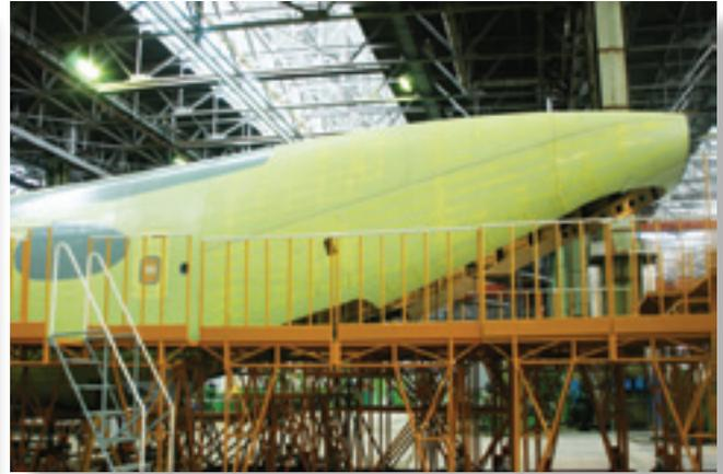
**Хвостовая часть фюзеляжа Ил-112В**
