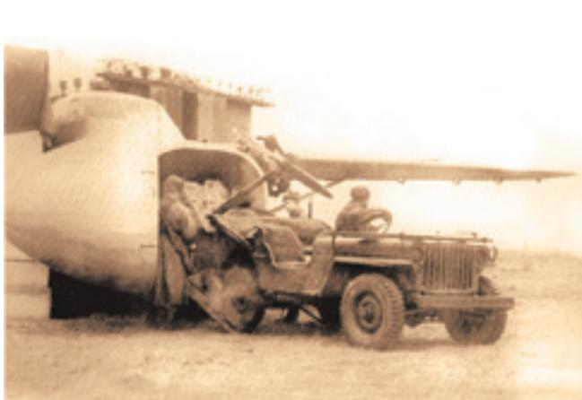
**Мотопланер Ц-25М. Мотор М-11 не имеет капотов. Автомобиль Виллис вытаскивает противотанковую пушку калибра 45 мм**
