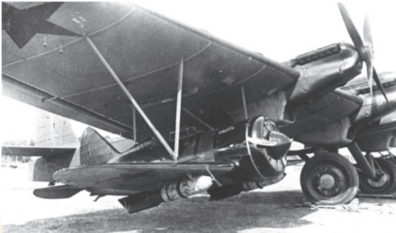
**«Звено СПБ»: И-16 тип 5 под крылом ТБ-3 4М-34РН. Сходная подвеска истребителя предполагалась на грузовом планере**
