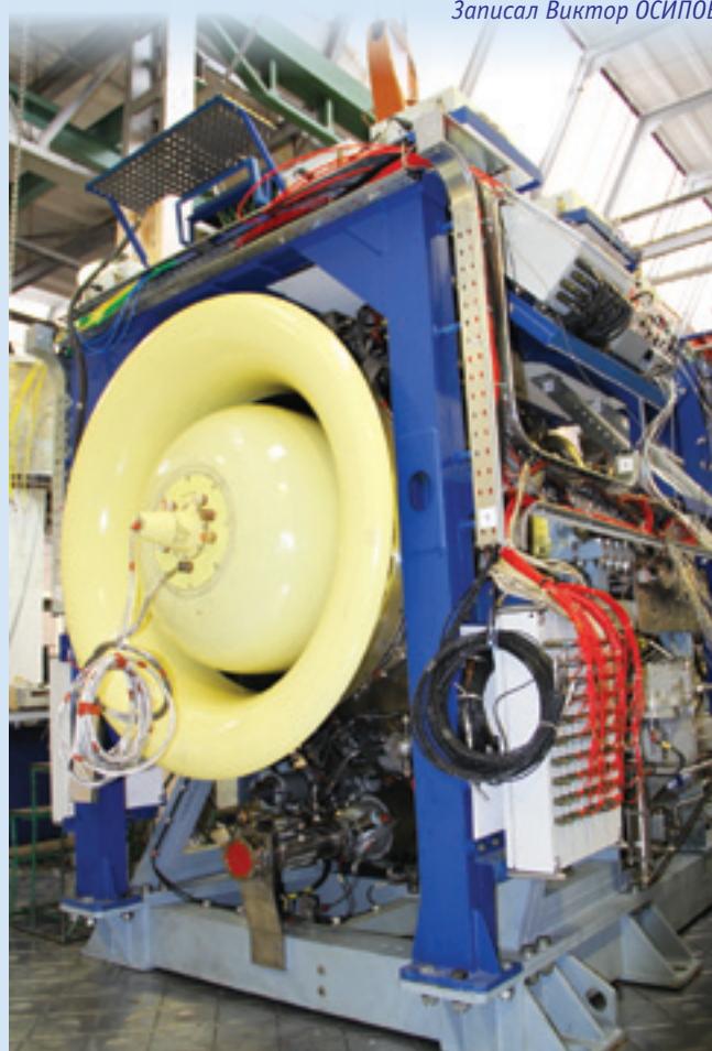
Газогенератор двигателя-демонстратора готов к очередному этапу испытаний
