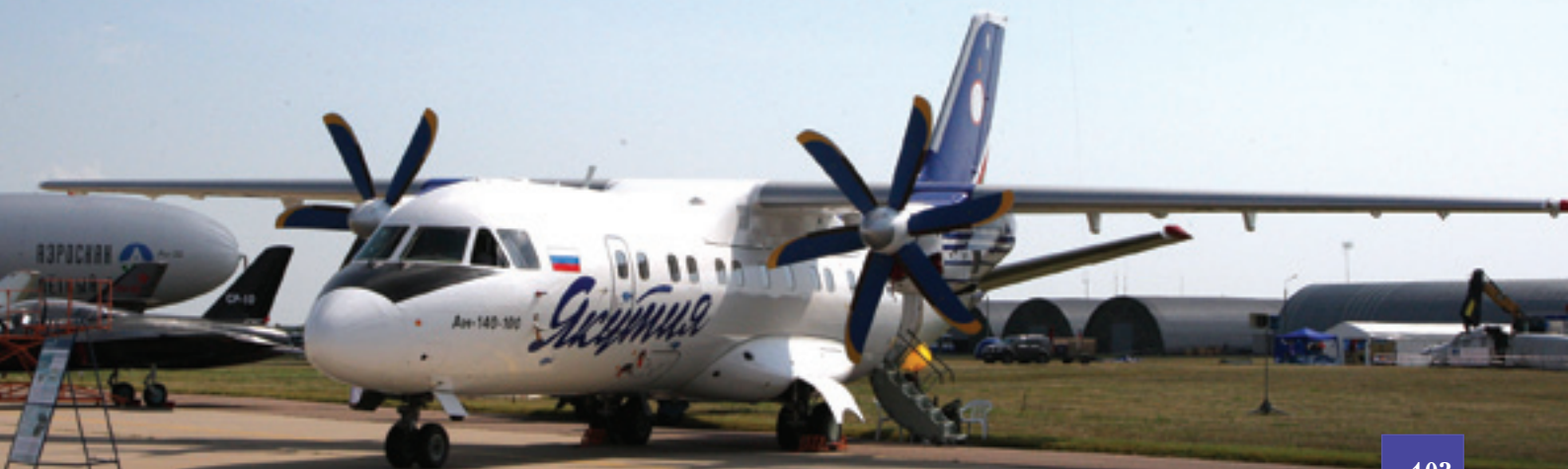
Самолет Ан-140 с двигателями ТВЗ-117ВМА-СБМ1
