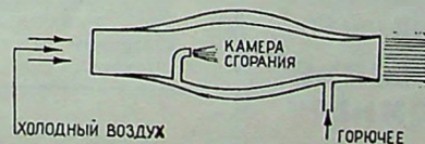
Рис. 3. Схема прямоточного воздушно-реактивного двигателя с двойными стенками.
